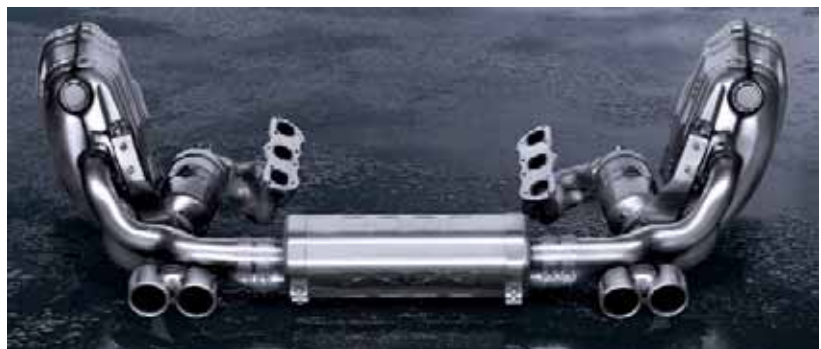
La figura muestra el sistema de escape de un Carrera S de 3,8 litros.
