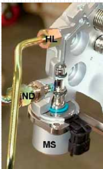
Figura seccionada de una válvula de regulación del caudal (Cayenne Turbo DFI)
