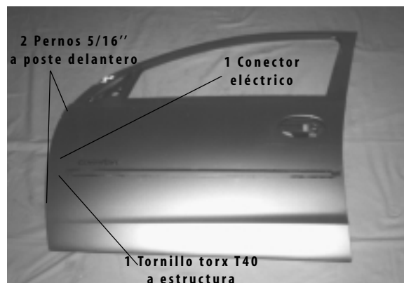
Figura 35 | Unión de la puerta delantera
