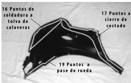
Figura 68 | Unión del costado
