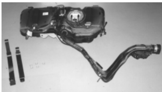
Figura 77 | Depósito de combustible
