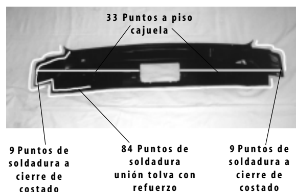
Figura 58 | Unión de la tolva de escape
