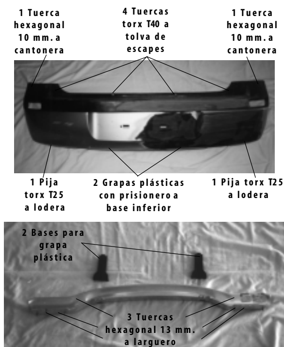
Figura 52 | Unión del conjunto defensa trasera
