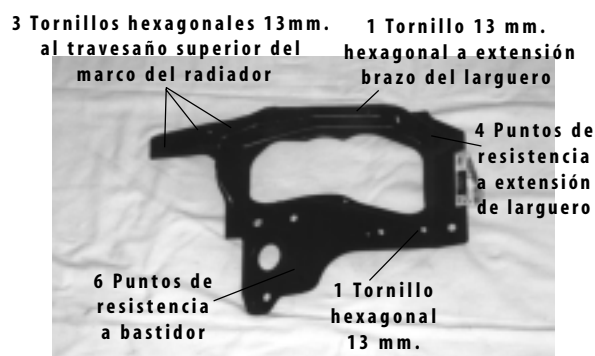
Figura 25 | Unión de la base del faro
