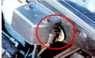
É efetuada pela ECU através da comunicação com o aparelho CHECK-UP I utilizando-se para isso uma linha de comunicação serial. Com esta comunicação é possível a aquisição de valores funcionais do veículo (parâmetros motores) e eventuais erros presentes na memória da ECU proveniente de algum sensor ou atuador.
