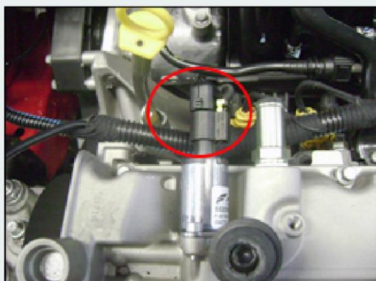
11 - Soltar o parafuso de fixação do sensor de fase e deslocá-lo;
