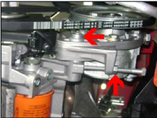
19 - Soltar a correia do compressor do ar condicionado/ alternador atuando no tensor;
