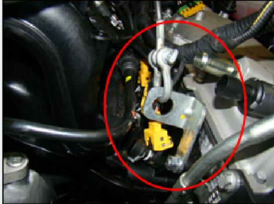
29 - Soltar o parafuso ao lado do coletor de admissão (lado do corpo de borboleta) e posicionar o cabo de aço para sustentação do motor - utilizar ferramenta (46744316);
