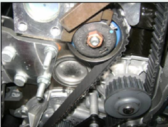
40 - Posicionar uma chave 24 mm no eixo comando de válvulas e apertar a engrenagem do comando de válvulas;
