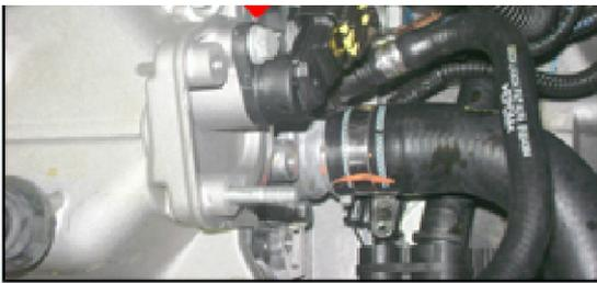
12 - Soltar o parafuso de fixação da presilha do chicote e do terminal massa na tampa de válvulas;
