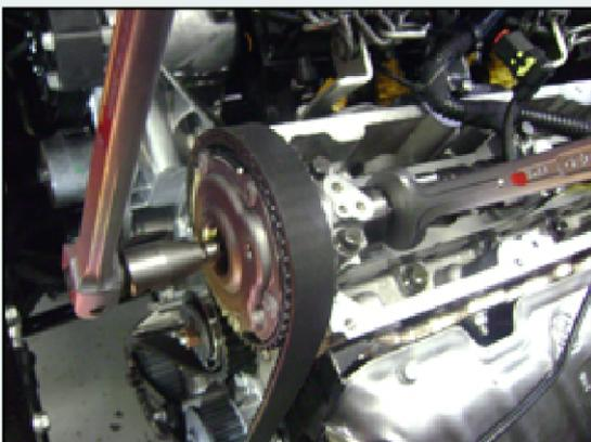
34 - Afrouxar o parafuso de fixação do tensor móvel da correia dentada e remova a correia;
