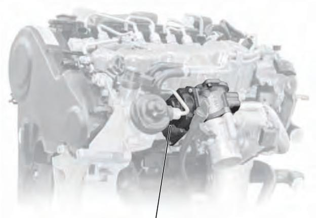
Válvula de recirculación N18 y transmisor de ángulo de la válvula de recirculación de gases de escape G212
