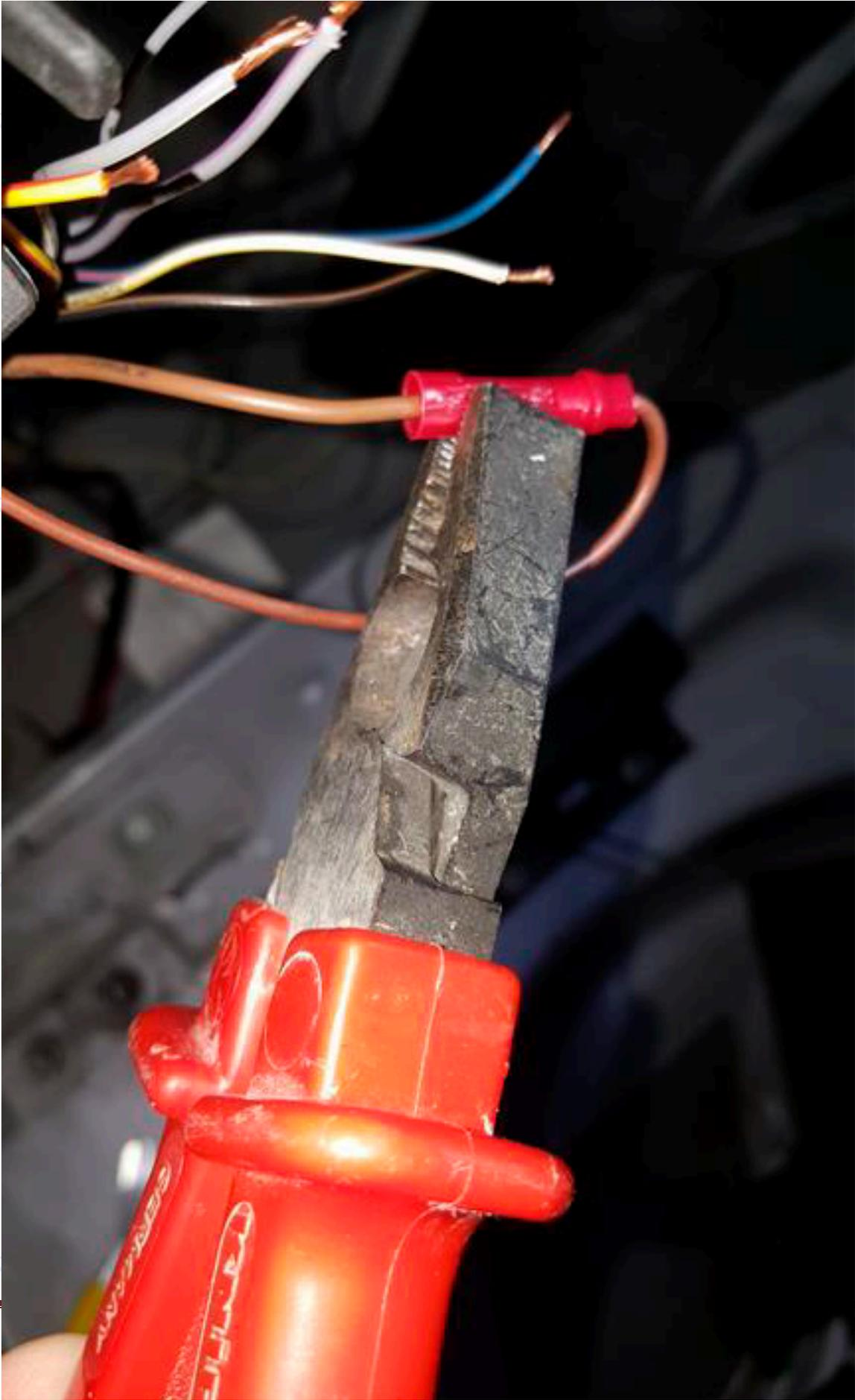
Vuelvo a repetir, cuidado con la correspondencia de colores, si bien el kit no coincide con los del vehículo, tan solo hemos de saber que cada cable del kit ha de conectar los dos extremos de los que hemos cortado y que coincide.
