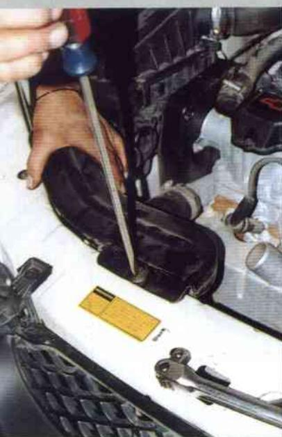
**1** Desmonta el filtro de aire del TBI, aflojando la abrazadera del tubo con un desarmador.
