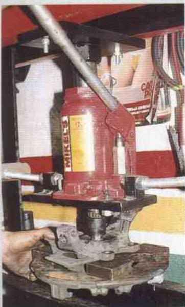
Colocamos nuevamente la masa en la prensa para socar el balero.
