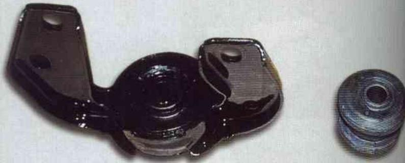
Los hidrobush son un par de elementos que se encuentran ubicados en la punta de cada una de las barras estabilizadoras de tu Chevy. Los puedes identificar fácilmente por su forma de mariposa metálica con un centro de goma.
