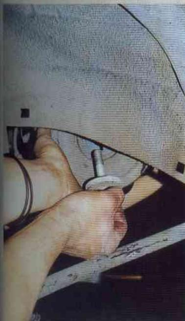
**7** Deslízate por debajo del auto, en la zona de la llanta que retiraste (copiloto), para sacar el tornillo de la polea.
