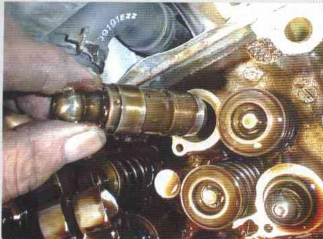
Para terminar, eliminamos las punterías manualmente.
