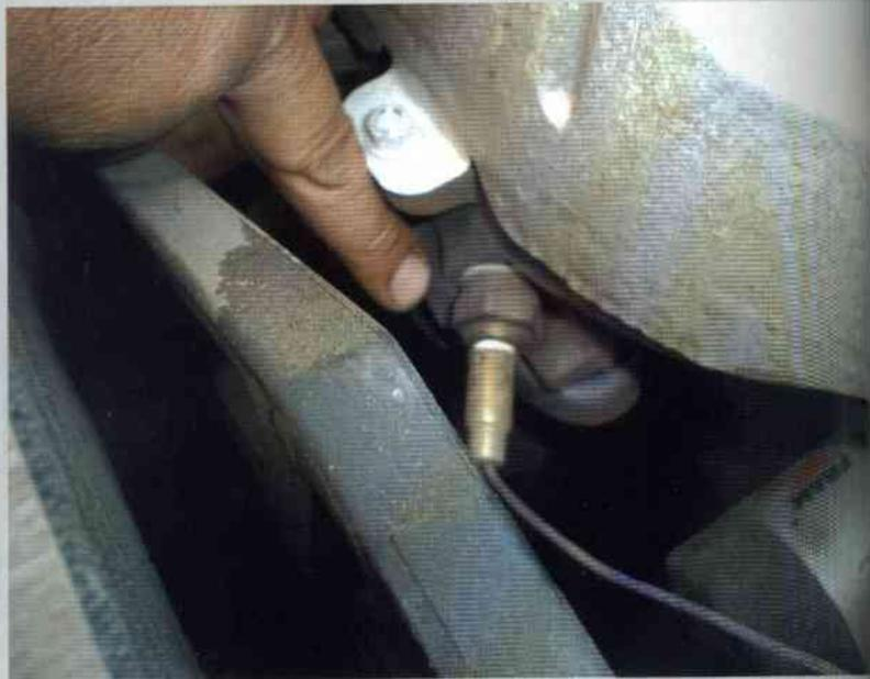
**SENSOR DE OXÍGENO:** Es un sensor de tipo generador químico que tiene como función mostrar a la computadora la cantidad de O2 que se encuentra en los gases del escape, en base a esta información la computadora se encarga de regular la entrega de combustible. Éste se ubica en la salida del múltiple de escape y ocasiona ciertas fallas en tu auto cuando deja
