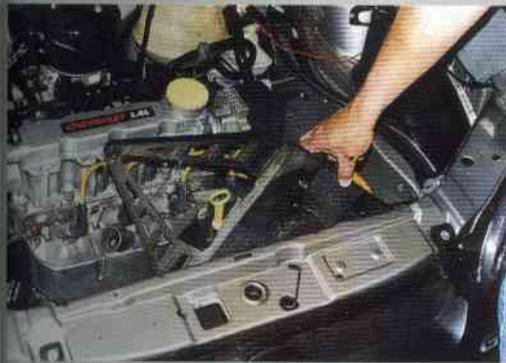
Con ayuda de la llave, el dado y la matraca, retiramos los tres tornillos que sujetan el ventilador.
