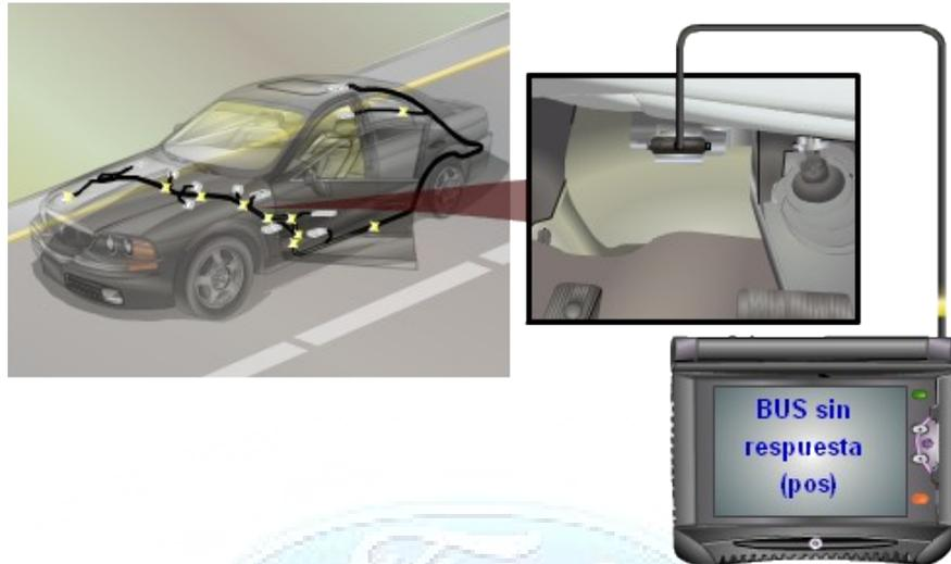
Si falla un cable del bus de datos, el vehículo puede no presentar problemas pero una prueba de la red identificará la falla y producirá un mensaje de falla.
