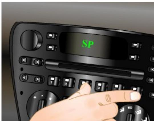
El módulo lleva a cabo un autodiagnóstico y los códigos se muestran en la pantalla del panel de control. Los códigos mostrados se pueden encontrar en el manual de taller junto con las instrucciones para probar los componentes ACP.
