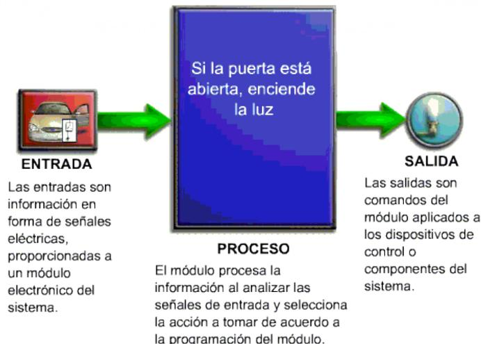
En este ejemplo simple, el interruptor de puerta entreabierta proporciona una señal de entrada al módulo. El módulo procesa la información, compara la información con su programación y envía un comando al dispositivo de salida. El dispositivo de salida reacciona al comando y las luces se encienden.
