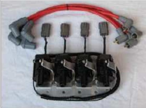
El kit además viene con unos cables de alta tensión con mayor aislamiento dieléctrico para poder soportar el nuevo nivel de tensión de disparo.
