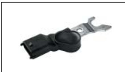
El sensor del árbol de levas trabaja según el principio Hall. Palpa una corona dentada que se encuentra en el árbol de levas. Mediante la rotación de la corona dentada, se modifica la tensión Hall del circuito integrado Hall que se encuentra en el cabezal del sensor. Esta tensión cambiante es transmitida a la unidad de control, donde se evalúa para determinar los datos necesarios.
