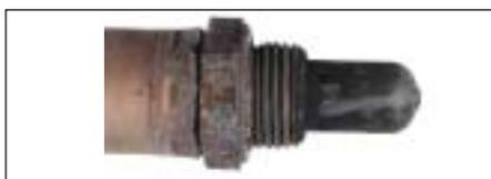
**El tubo protector está cubierto de gran cantidad de hollín:** el motor funciona con una mezcla demasiado rica. La sonda deberá sustituirse y la causa de que la relación sea demasiado rica deberá eliminarse para evitar que la sonda vuelva a cubrirse de hollín.
