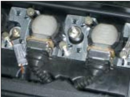
Si aparecen fallos en el sistema de encendido, puede que tenga que realizarse una larga revisión hasta detectar el fallo. Sin embargo, para evitar la realización de trabajo innecesario, habría que comenzar con una inspección visual del sistema.
