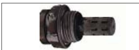
**Montaje incorrecto:** Un montaje incorrecto puede dañar la sonda Lambda y no puede asegurarse su buen funcionamiento. Para el montaje se debe utilizar la herramienta especial prescrita y respetar el par de apriete.
