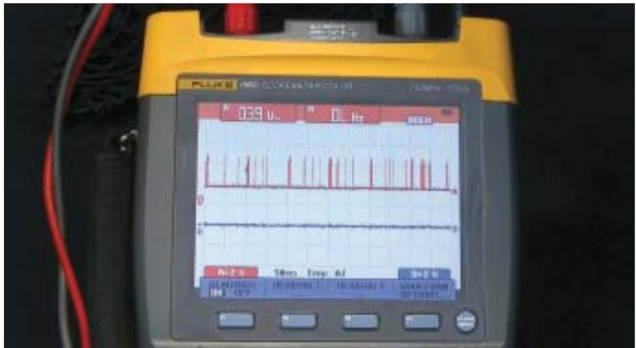
Para conectar el osciloscopio con el bus de datos CAN, la conexión deberá realizarse en un lugar apropiado. En general, la conexión se realiza en la conexión de enchufe entre la unidad de control y la línea de bus de datos CAN. En el vehículos que hemos tomado como ejemplo, en el lado del copiloto, en la canaleta para cables situada debajo de la regleta para el apoyapies (figura) se encuentra un distribuidor de potencial.
