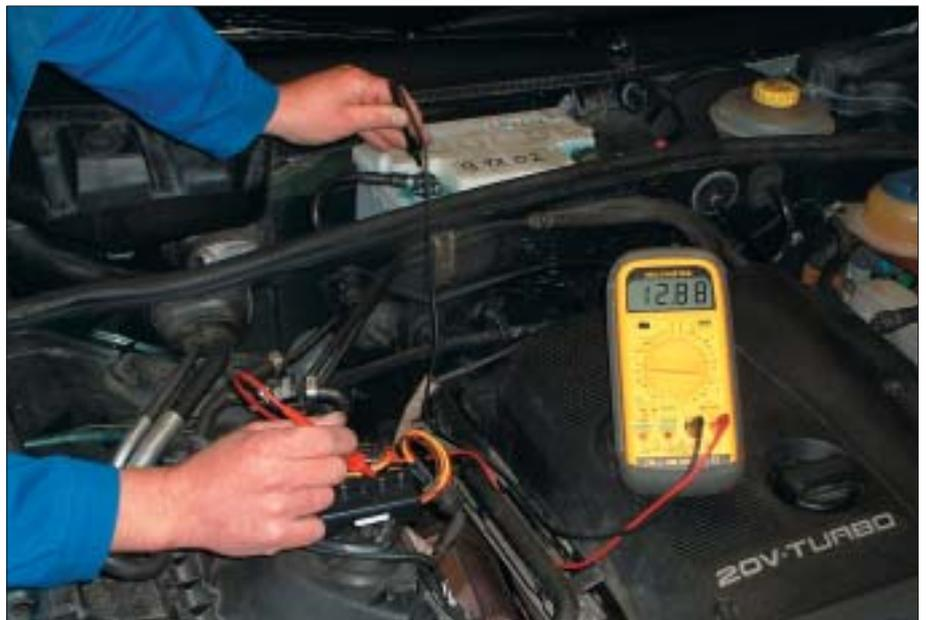
Medición con cable adaptador
