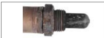
**Incrustaciones brillantes en el tubo protector:** utilización de combustible con plomo. El plomo destruye la resistencia de la sonda. La sonda deberá sustituirse y el catalizador deberá revisarse. Se debe sustituir el combustible con plomo por combustible sin plomo.
