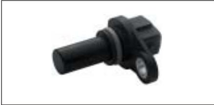
En función de su construcción, existen dos tipos de sensores de transmisión: transmisores Hall y transmisores inductivos. El movimiento rotativo de la corona dentada genera una variación del campo magnético que altera la tensión. El sensor de transmisión transmite estas señales de tensión a la unidad de control.
