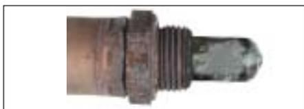
**Incrustaciones de color claro (blancas o grises) en el tubo protector:** el motor quema aceite; aditivos adicionales en el combustible. La sonda deberá sustituirse y la causa por la que se produce una combustión de aceite deberá eliminarse.
