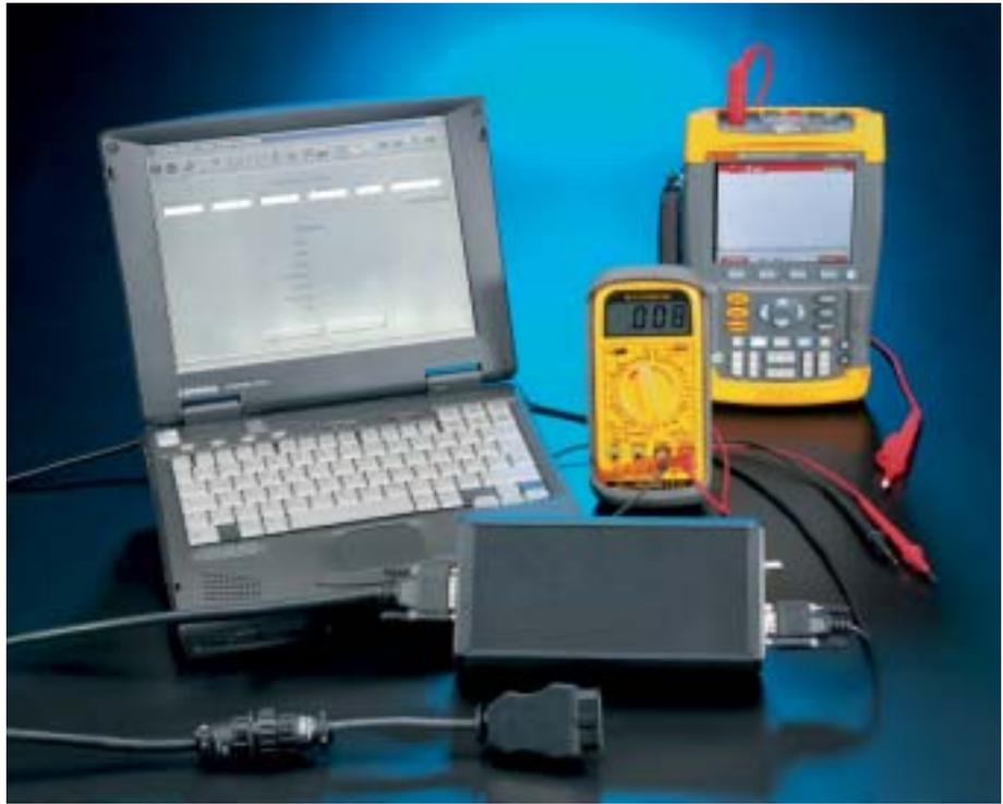
La experiencia demuestra que la mayoría de las averías se producen por conectores defectuosos, cables rotos o conexiones a masa estropeadas. Normalmente, estas averías pueden localizarse mediante un multímetro u osciloscopio.
