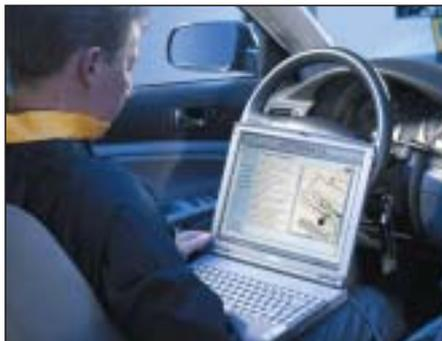
Según el sistema del vehículo y el equipo de diagnóstico es posible descubrir fallos en el sistema de encendido. Sensores o bobinas defectuosas pueden estar registrados en la memoria de códigos de avería, si se ha llevado un control de incidencias.
