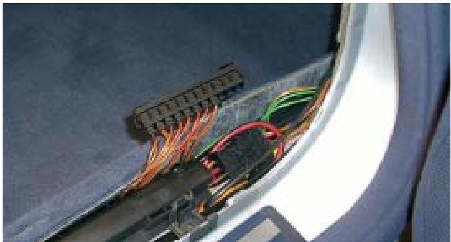
Aquí concurren todas las líneas de bus de datos de las unidades de control. El osciloscopio puede conectarse sin problemas a este distribuidor de potencial.
