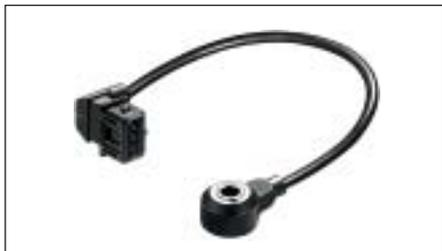
El sensor de picado "escucha" las vibraciones del sonido propagado por estructuras sólidas y las transforma en señales de tensión eléctricas. Éstas son filtradas y evaluadas por la unidad de control. La señal de picado se asignará al cilindro correspondiente. Cuando se produce el picado, la señal de encendido para el cilindro correspondiente será desplazada en dirección "tarde" hasta que desaparezca la combustión por pulsos.
