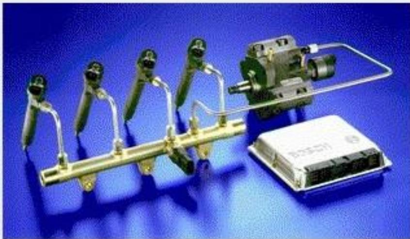
Debido a la alta presión siempre presente en el acumulador de alta presión ("Rail") es posible realizar una inyección de dosificación muy precisa y de manera muy flexible. Así es posible, p. ej., mejorar notablemente la combustión durante la inyección principal, inyectando previamente una pequeña cantidad de combustible.
