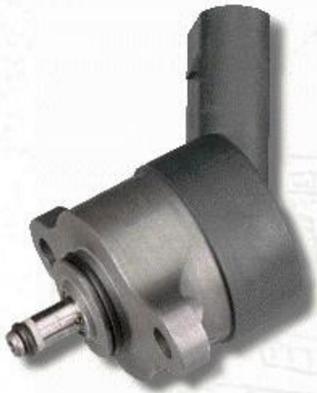
La misión de la válvula reguladora de presión (DRV) es mantener constante la presión en el acumulador de alta presión (Rail) de acuerdo al régimen del motor. Si la presión en el Rail es demasiado elevada se abre la DRV y se retorna combustible hacia el depósito. Si la presión en el Rail es demasiado baja se cierra la DRV y la bomba puede generar la presión en el Rail.
