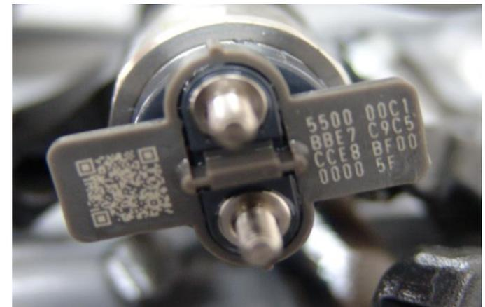
**El inyector inyecta el combustible a alta presión dentro de la cámara de combustión en el preciso momento, con la cantidad necesaria con los comandos recibidos de la ECM**
