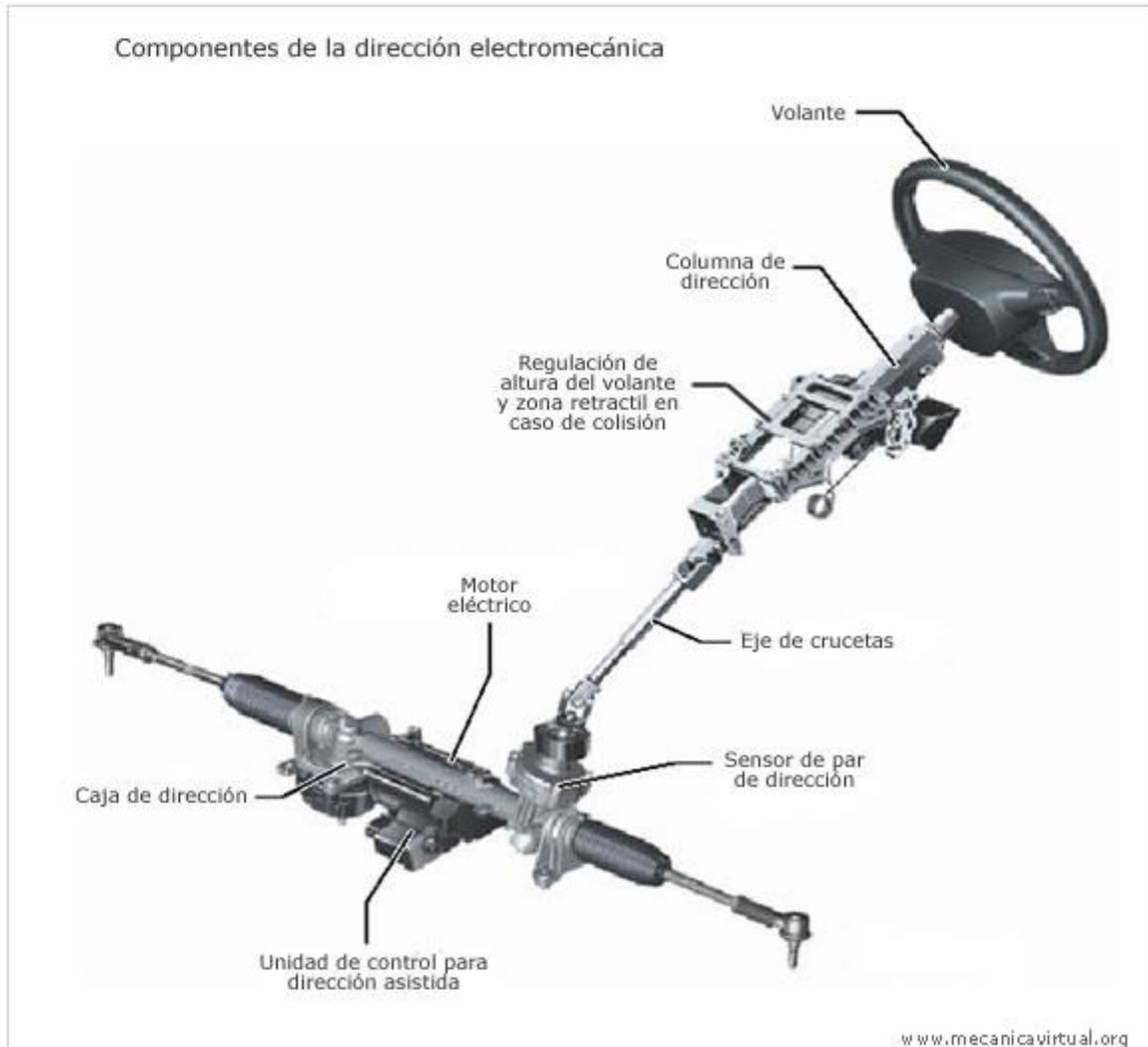
Despiece de los componentes de una servodirección electromecánica
