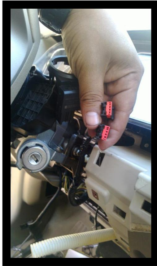
Caso de Jetta 2010 2.5 con circuito de inyector en corto a positivo, y con la entrevista al cliente dimos con la solución, resultado que el cliente lo choco con una piedra y golpeo el abanico, así fue como el abanico presiono el mazo de cables.
