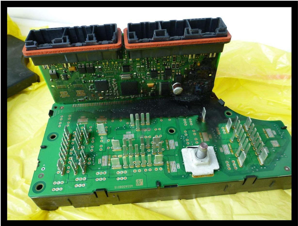
Relevadores de cajas de fusibles de Nissan llamado IPDM, con un daño común en el relevador de control electrónico de motor después de cierto kilometraje.
