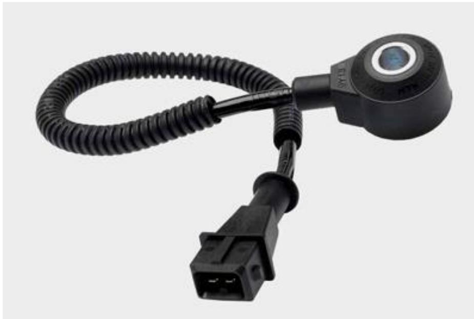
Los Sensores de Detonación se diferencian por su Sensibilidad (S). La sensibilidad es la relación entre la tensión generada entre sus terminales y, la aceleración a la que está siendo sometido. Se expresa en mVolts/g.
