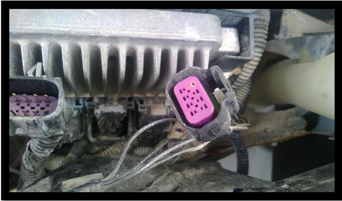
Mustang 2007 con situación de no arranque, ni comunicación con PCM, esto provocado por un choque frontal y no dejaba hacer bien el contacto con el arnés principal de la computadora.
