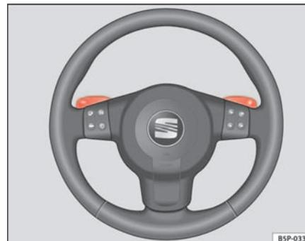
Fig. 139 Volante con palancas para cambio automático
