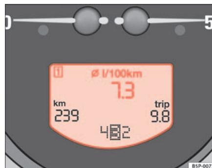
Fig. 40 Pantalla digital del cuadro de instrumentos: indicador consumo medio de combustible
