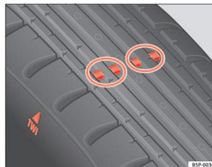
**Fig. 168** Indicadores de desgaste del perfil del neumático
