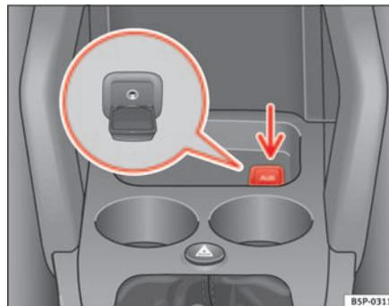
Fig.117 Conector para la entrada auxiliar de audio
