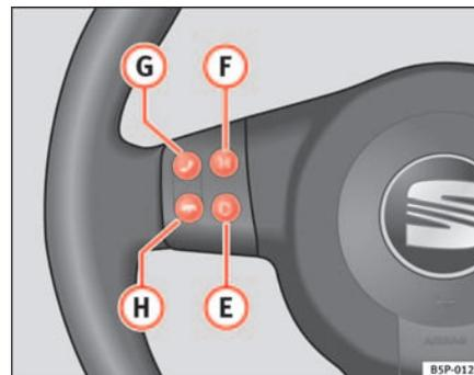
Fig. 56 Mandos en el volante Audio + Teléfono
