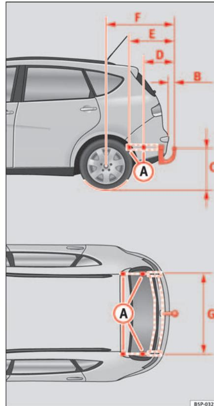
Fig. 155 Puntos de fijación del dispositivo de remolque
