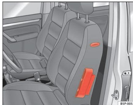
**Fig. 22** Airbag lateral en el asiento del conductor
