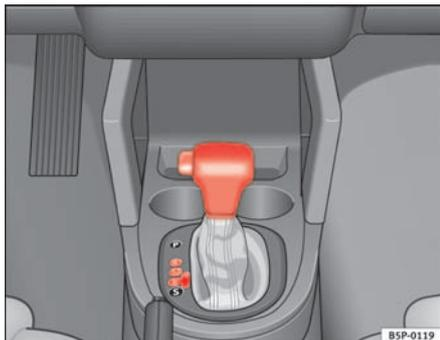
Fig. 136 Desactivación del bloqueo
