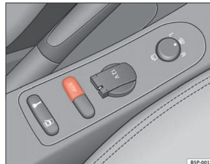
**Fig. 130** Detalle de la consola central: tecla ESP
