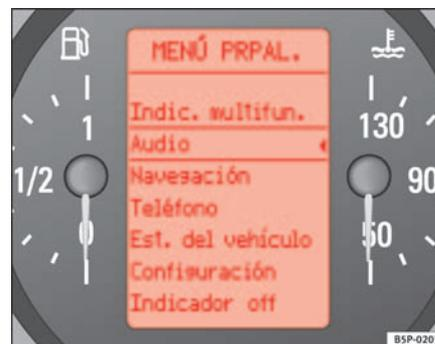
Fig. 44 Pantalla digital del cuadro de instrumentos: Menú principal
