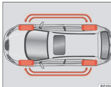
**Fig. 169** Esquema para el cambio de ruedas
