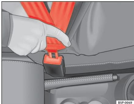
**Fig. 12 Cierre y lengüeta del cinturón de seguridad**
