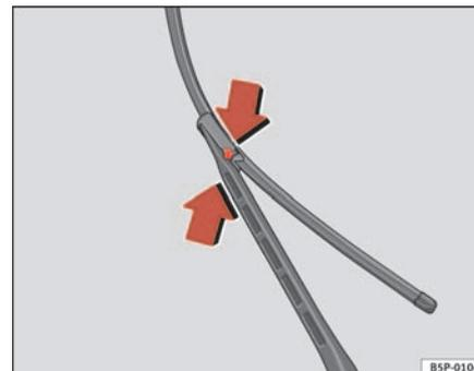
Fig. 165 Cambio de las escobillas del limpiaparabrisas
