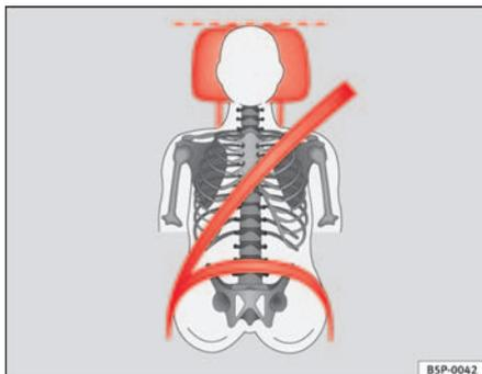
**Fig. 3 Apoyacabezas ajustado correctamente visto de frente**
