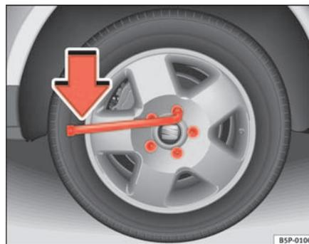
**Fig. 172** Cambio de rueda: aflojar los tornillos de rueda
