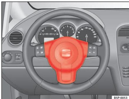
**Fig. 18** Airbag del conductor en el volante
