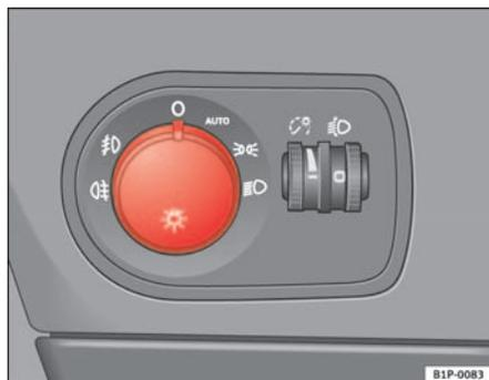
Fig. 74 Encendido automático de luces
