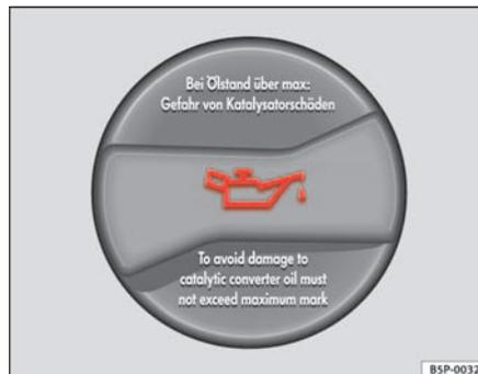
**Fig. 161** Tapón de la boca de llenado de aceite del motor en el vano motor
