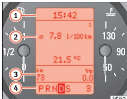
Fig. 38 Pantalla digital del cuadro de instrumentos
