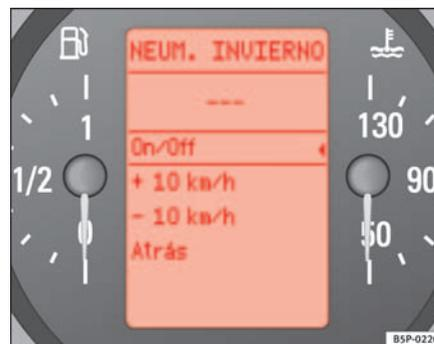
Fig. 46 Pantalla digital del cuadro de instrumentos: indicador de neumáticos invierno
