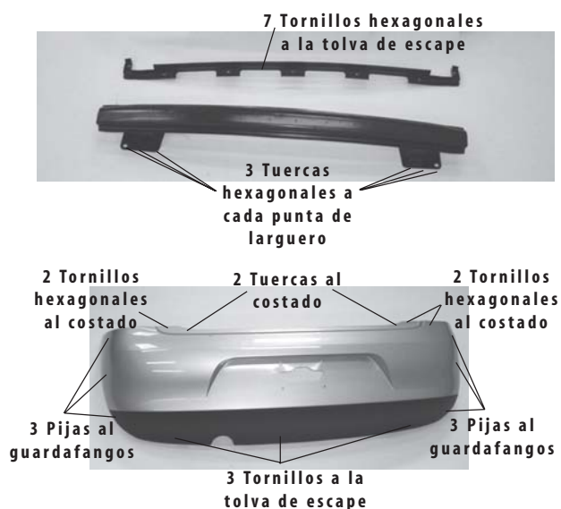
Figura 42 | Unión del conjunto defensa trasera
