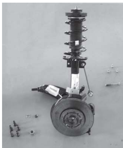
Figura 62 | Conjunto media suspensión delantera
