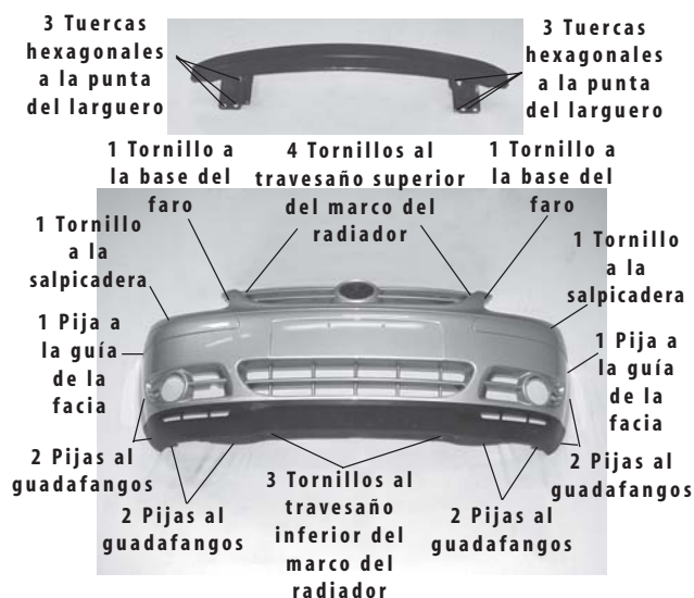
Figura 12 | Unión de la fascia delantera
