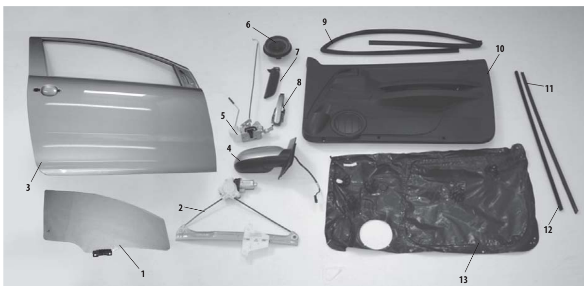
Figura 36 | Elementos que componen la puerta
