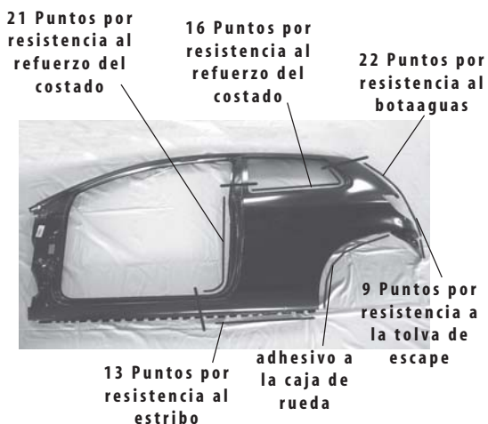
Figura 55 | Unión del costado
