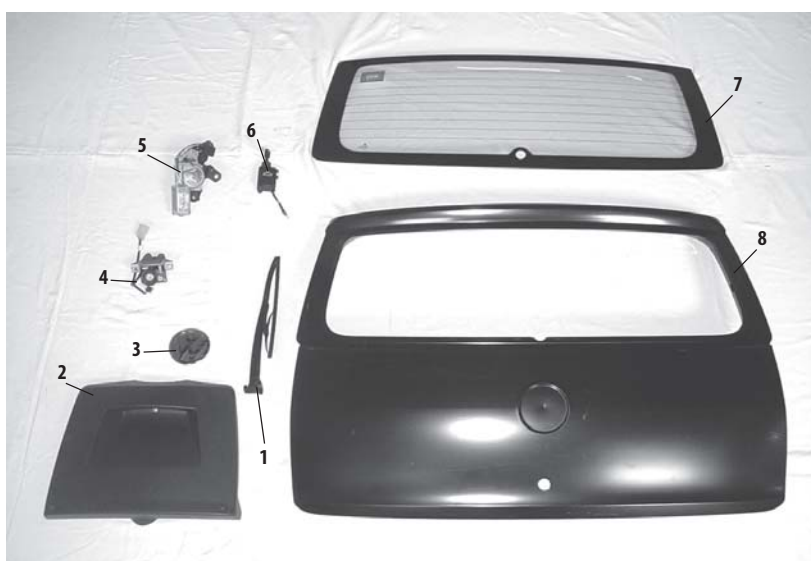
Figura 53 | Elementos que componen la tapa cajuela
