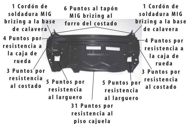
Figura 48 | Unión de la tolva de escape
