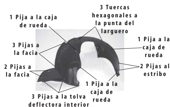
Figura 14 | Unión del guardafangos delantero
