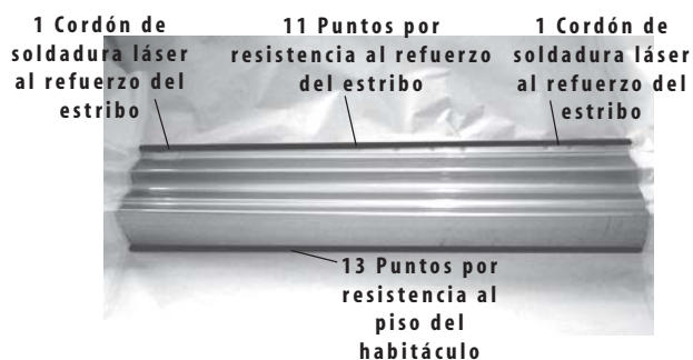
Figura 38 | Unión del estribo
