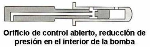
La presión atmosférica se aplica al lado superior del diafragma del APC. Si la presión atmosférica disminuye, el perno deslizante se mueve verticalmente alejándose del tope inferior y, de manera similar al LDC, la palanca de reversa produce que la cantidad de combustible inyectado se reduzca.
