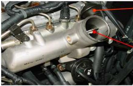
Actuador de la Válvula de Control de Aire
