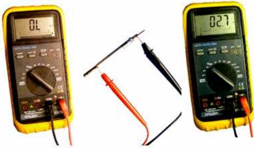
Revisión de resistencia de las bujías
