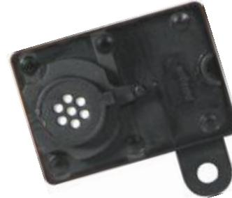
Función: Controlar la calidad del aire procedente del exterior y detectar el monóxido de Carbono (CO) y el dióxido de nitrógeno (NOx) para poder cerrar o mantener abierta la trampilla de reciclaje.
