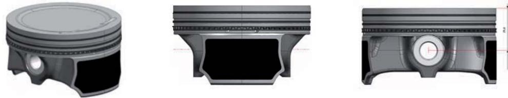
Los pistones de los nuevos motores 1.6 y 1.8 reciben un tratamiento superficial de tipo “anodizado” en la región de la cabeza del pistón, para garantizar una superficie de menor rugosidad. Este tratamiento tiene por objetivo reducir la acumulación de carbón, mejorando las emisiones, en especial de HC.
