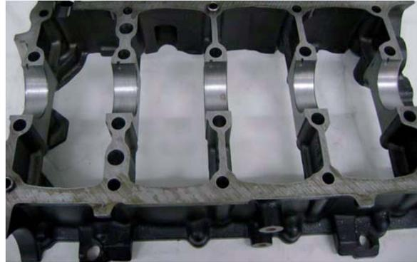
En la región del block se encuentran los ***"Jet cooling"*** o inyectores de aceite. Ellos sirven para refrigerar los pistones, reduciendo así su temperatura de trabajo.
