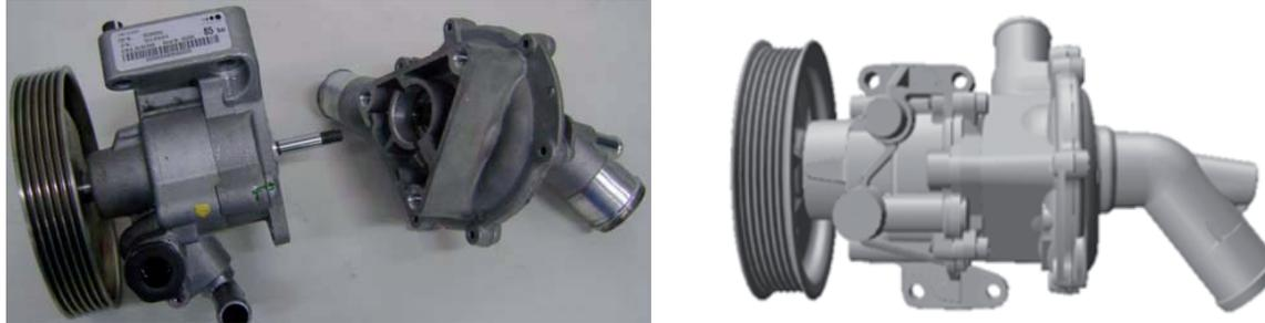
En algunas aplicaciones que utilizan dirección eléctrica, la bomba de la dirección hidráulica será eliminada. De este modo, los vehículos equipados con dirección eléctrica utilizan otro tipo de conjunto.
