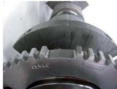
En la parte frontal se fija el tren de distribución, accionada mediante cadena. En la parte trasera, la rueda fónica está sujeta al propio eje, e informa a la central de inyección "NCM" la rotación del motor y el PMS.
