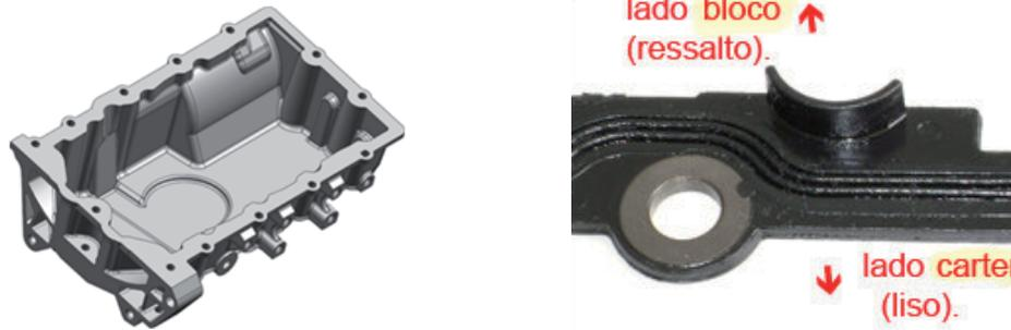
La junta de sellado del carter es de goma. Para el montaje, debe observarse la posición conforme a la ilustración. Para mayores detalles consultar en Infotec.
