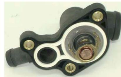
Localizada en la parte trasera de la tapa de cilindros, controla el flujo de agua hacia el radiador. Para la sustitución, verificar información en Infotec.
