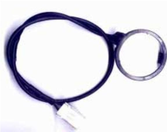
Cuando se acciona la llave de contacto, la unidad de mando del inmovilizador genera una corriente alterna que circula por la bobina produciendo un campo electromagnético, que como se ha explicado antes, provocará la alimentación de tensión de la llave. También se ha indicado que el transponder de la llave emite en estas circunstancias una señal por radiofrecuencia, señal que es captada por
