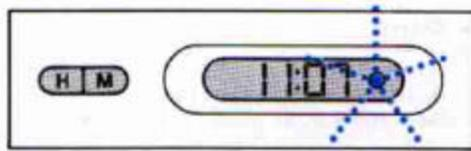
El led se encuentra alojado en el reloj. Si el vehículo lleva instalado además un sistema de alarma, el led sirve para ambos aunque dará prioridad al PATS.
