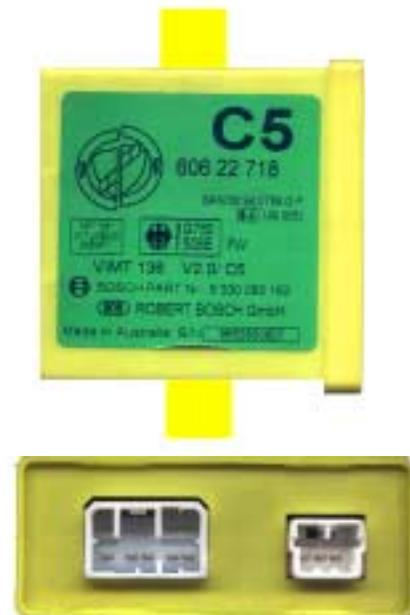
El código de la llave MASTER es el código principal (Master CODE) memorizado en la centralita de control del motor y en la centralita Fiat CODE; por eso la centralita de control del motor y la llave MASTER están indisolublemente unidas. **Si se pierde o se estropea la llave MASTER, no se podrán memorizar llaves nuevas; sin la llave MASTER, si se avería la**
