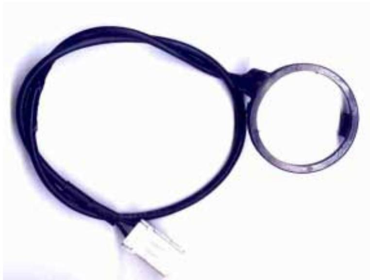
Unidad lectora, que actúa como fuente de alimentación y como antena. Tiene forma de anillo y está colocada en la parte superior del contactor de la llave de contacto.
