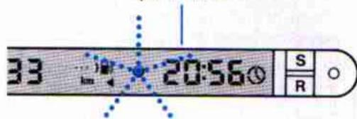
La luz empezará a parpadear muy rápido (100 ms encendida / apagada) (en determinados modelos que sólo tienen activación manual) o permanecerá iluminada durante tres segundos antes de pasar al modo parpadeante, mientras se mantiene pulsado el botón del mando a distancia. Esto indica que el código recibido por el inmovilizador proveniente del mando a distancia es correcto.
