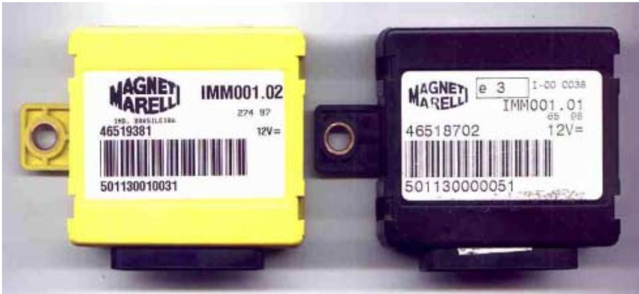
Unidad de mando del inmovilizador, situada usualmente cerca de la columna de dirección, bajo el tablero. Existe la tendencia a incluirla dentro de otros componentes, como por ejemplo el cuadro de instrumentos o junto con la misma antena.
