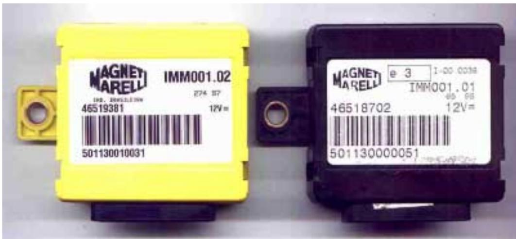
\*La central de inmovilizador del lado izquierdo es de color amarillo y se coloca en los vehículos con inyección diesel convencional mientras que la de la derecha corresponde al sistema con inyección electrónica naftera y es de color negro.
