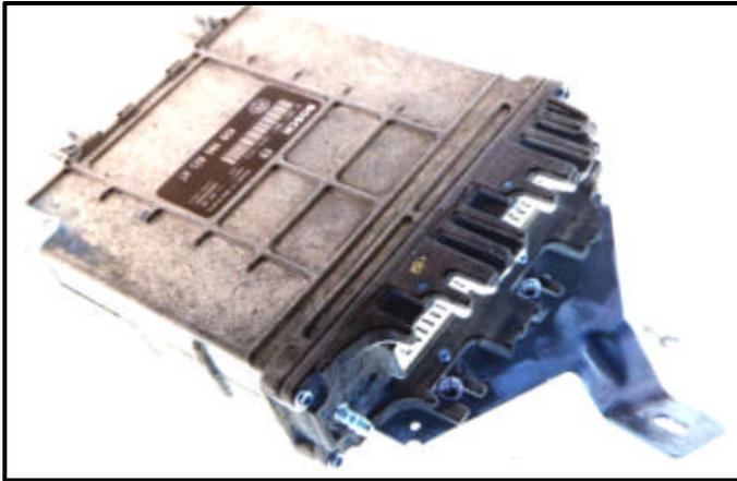
La modificación de los circuitos internos de las unidades, ha sido necesaria para asumir la función de bloqueo para la puesta en marcha del motor, y para permitir la transmisión de datos con el nuevo módulo inmovilizador.
