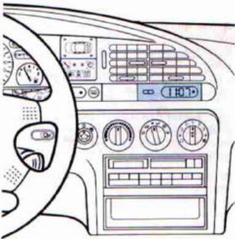
En caso contrario, aunque el motor de arranque haga girar el motor, éste no se pondrá en marcha ya que el PATS no se ha desactivado y el motor está aún inmovilizado.
