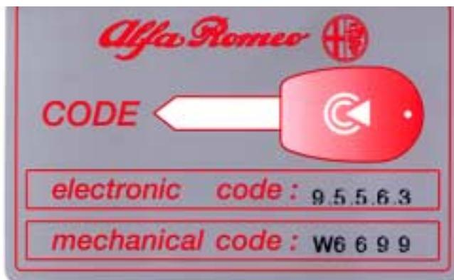
Si la llave master sufre una avería, no es posible ni la programación de nuevas llaves ni el arranque del motor. Junto con esta llave se entrega al cliente una tarjeta (La CODE CARD) donde aparecen dos códigos. Uno corresponde a la codificación mecánica (mecanizado) y el otro, de cinco cifras, que es el código electrónico que será necesario
