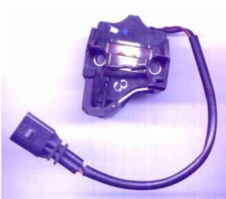
El DDS cumple con la misma función con respecto al inmovilizador que la unidad de mando del motor, es decir, tiene un código que es emitido hacia la unidad del inmovilizador y recibe el código de desbloqueo desde la misma. Este elemento evita el arranque del motor cortando el suministro de corriente a la válvula de par de motor.
