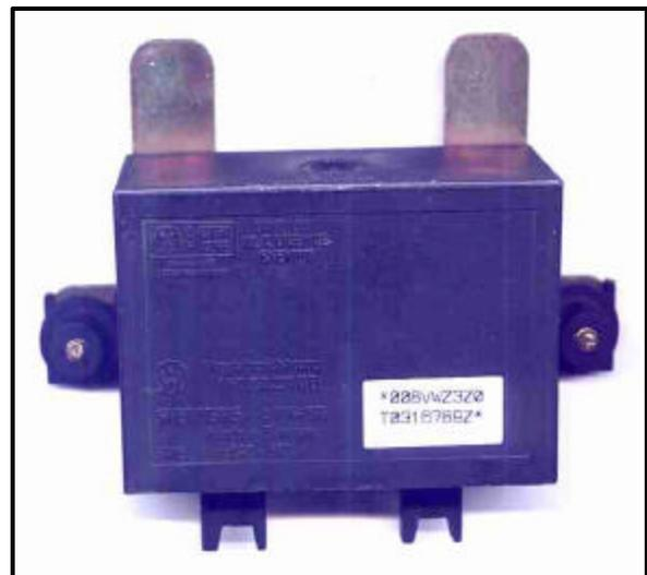
El módulo inmovilizador consta básicamente de un procesador y de una memoria programable (EEPROM).
