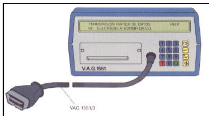
Si se presentan fallas de funcionamiento en los componentes o en la transmisión de datos estos se almacenan en la memoria permanente de averías del módulo inmovilizador.
