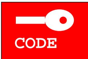
El testigo CODE está dirigido por la centralita Fiat CODE. El testigo CODE está situado en el tablero de instrumentos. Al girar la llave de arranque a la posición MARCHA (+15) el testigo puede indicar una de las siguientes situaciones:
