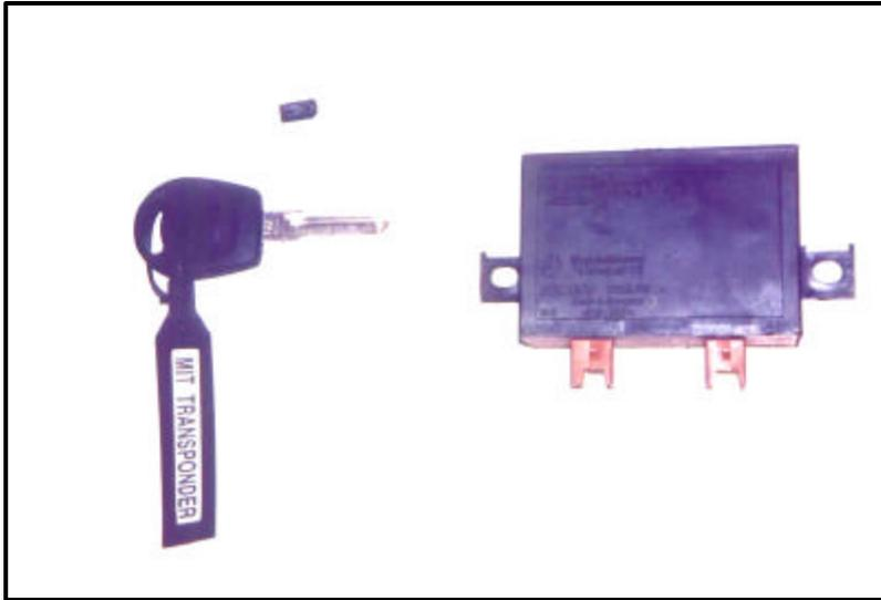
Una vez con alimentación, el circuito emisor emite una señal de radiofrecuencia, que es recogida por la unidad de lectura, siendo transformada en una señal eléctrica en dirección al módulo inmovilizador.
