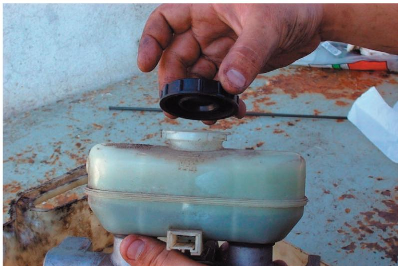
Saca el líquido de frenos de los depósitos de la bomba.
