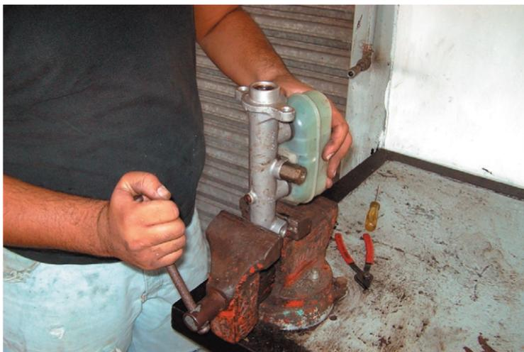
En caso de que la rosca del orificio de la bomba de la línea de alta presión esté dañada, reemplaza la bomba.
