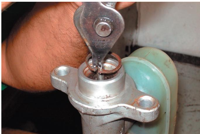
Suelta lentamente el pistón primario hasta que salga del cilindro maestro.
