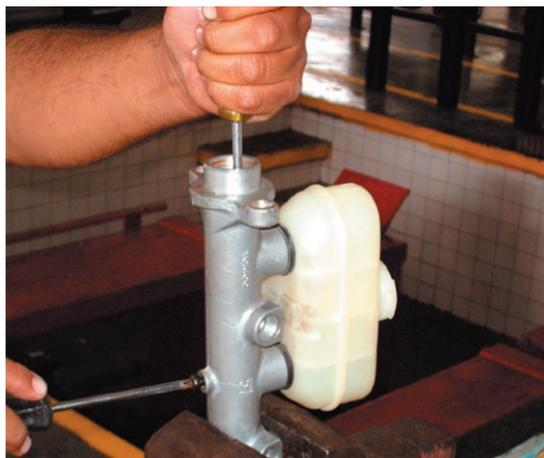
Lubrica con líquido de frenos el pistón primario.
