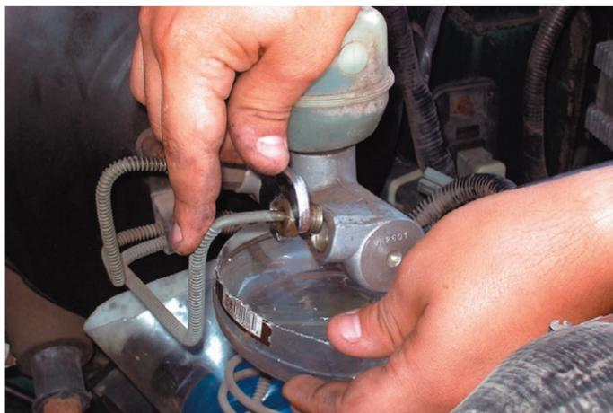
Retira los tornillos o tuercas que sujetan la bomba con el boster. Nota: En caso de que el sistema no tenga boster, desconecta la bomba del pedal del freno de su perno de anclaje.
