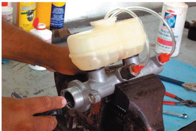
Comprueba la ausencia de burbujas de aire en los depósitos y cuando esto ocurra la bomba estará purgada
