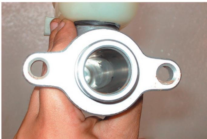
En caso de que el cilindro maestro presente ralladuras, procede a asentarlos usando un pulidor de cilindros de freno o lija.
