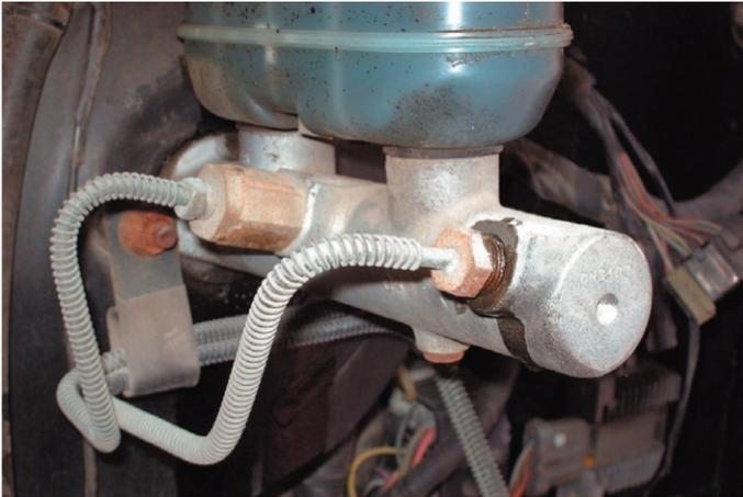
Verifica que no exista fuga entre los sellos de neopreno de la bomba y los conductos del depósito remoto del líquido de frenos. En caso necesario reemplaza los sellos.
