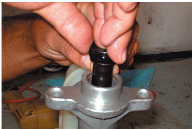
Oprime el pistón primario usando un desarmador.
