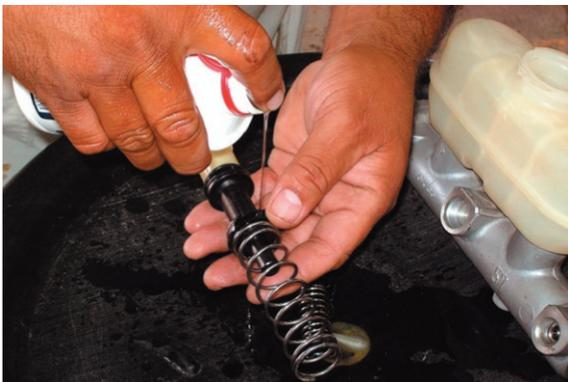
Presiona el pistón secundario dentro del cilindro maestro usando un desarmador y coloca el tornillo perno del pistón secundario en caso de contar con ello.
