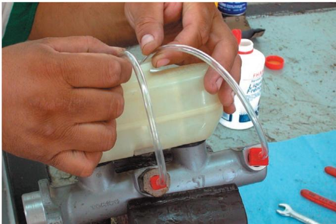
Rellena los depósitos con líquido de frenos.
