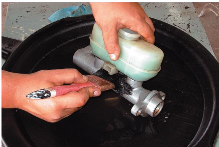
Inspecciona el cilindro maestro para verificar que esté libre de picaduras, en caso contrario reemplaza la bomba.
