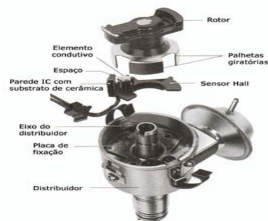
Figura 15. Sensor de rotação de efeito hall (presente no distribuidor) [15]
