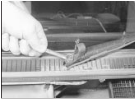
16.3 Slackening the wiper arm nut
