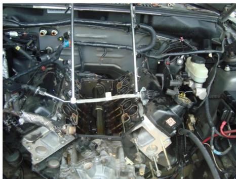
**Fig. 1.4 Motor en "V" Mustang 4.2 L.**
