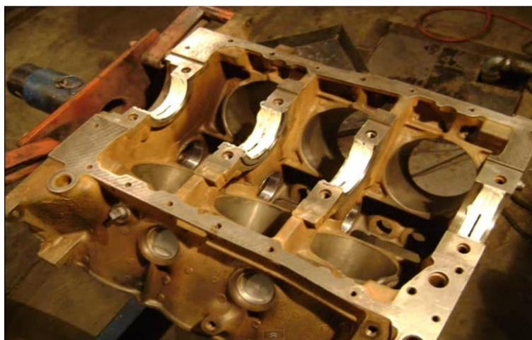
**Fig.4.3 Posición de los metales de Bancada.**
