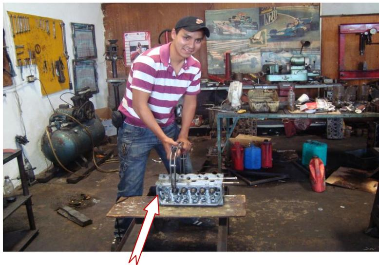
Fig. 2.8 Opresor de resorte de válvula.
