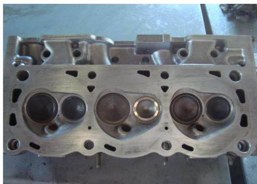
**Fig. 3.2 Culata ó cabeza del motor.**
