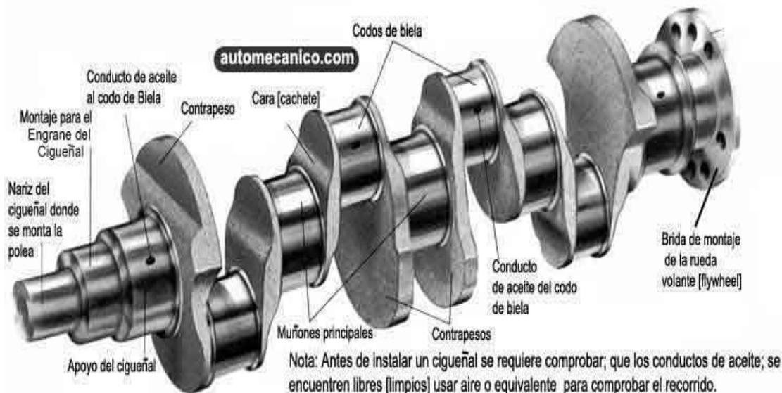
**Fig.3.26 Componentes del cigüeñal.**
