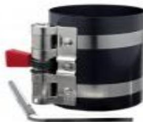
**Fig.2.7 Opresor de anillos.**
