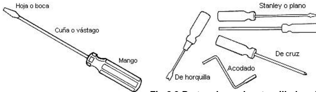
Fig.2.9 Partes de un desatornillador. Fig.
