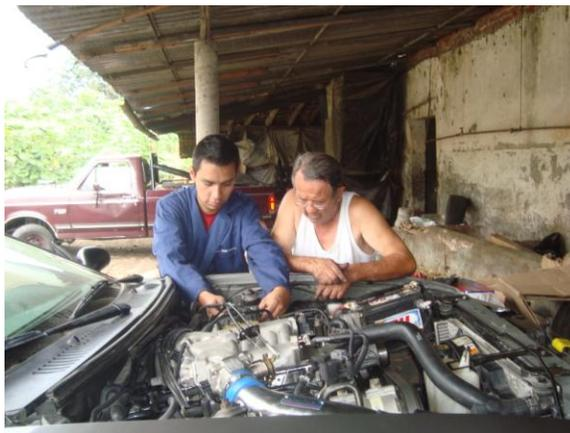
**Fig.4.27 Instalación de los cables de la bobina a las bujías.**
