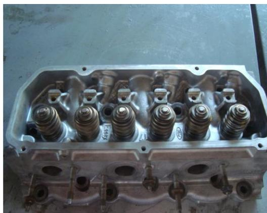
**Fig.3.3 Culata vista de los balancines**
