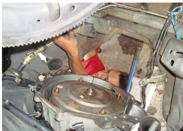
Fig.4.25 Instalación del motor en la caja de velocidades.
