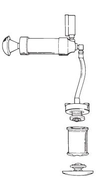
Figure 1-8. Pressure Cap Test Hookup.
