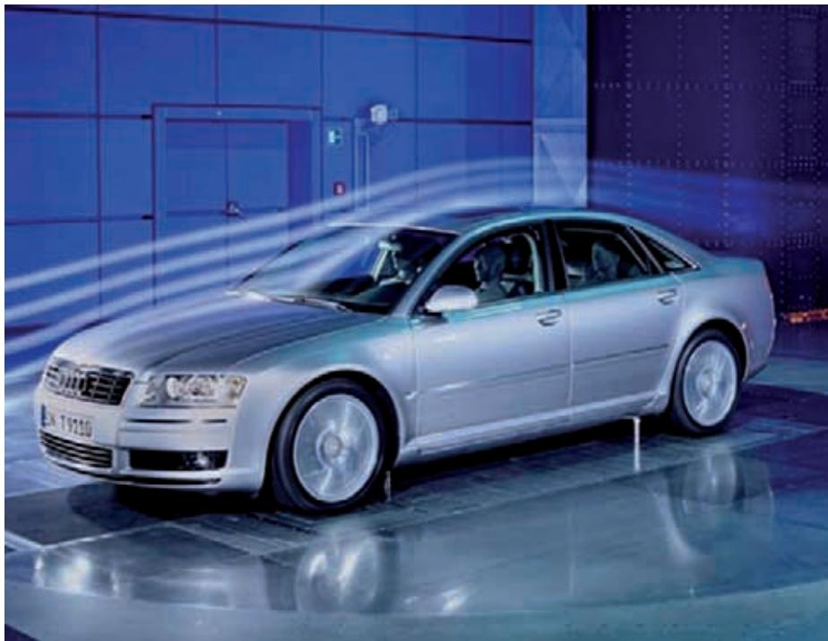
↑ **Figura 1.5.** Prueba en túnel de viento del  $cx$  de un Audi A8.
