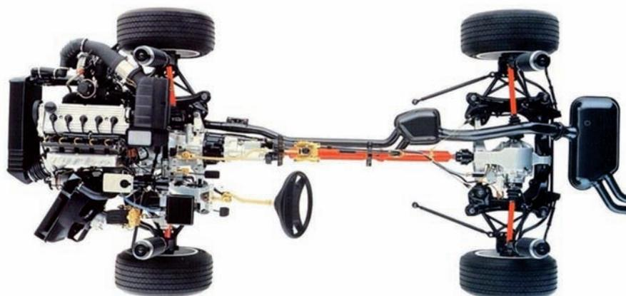
↑ **Figura 1.1.** Conjunto motor, cambio y transmisión del Audi Quattro.
