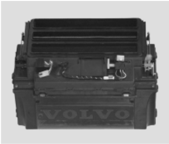
Unidad de Control de Clima de la Cabina
