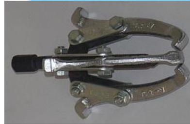
\* Se retira el tornillo y la arandela del retén del acoplamiento de impulsión de la bomba de inyección, se coloca el extractor para retirar el acople de accionamiento y con el retirar la tapa.
