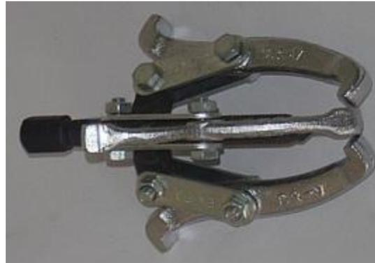
Se lo utiliza para sacar él acople de accionamiento de la flecha principal de la bomba.
