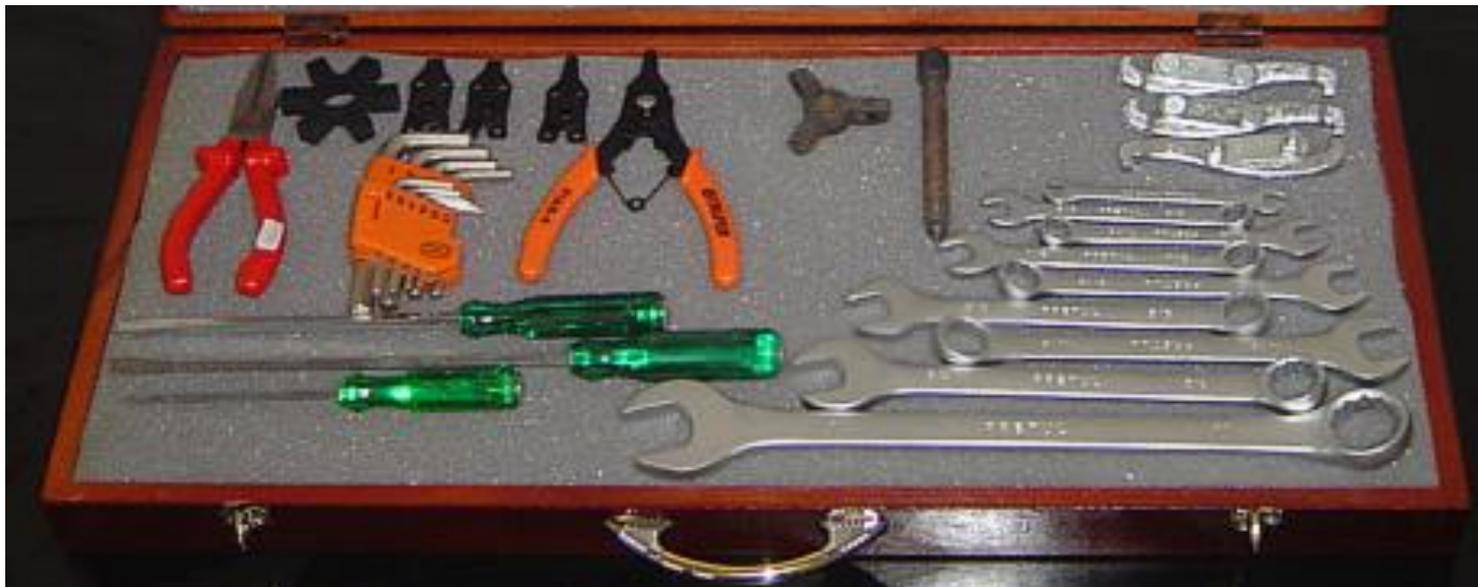
Las Herramientas para el desarmado, armado y comprobación de esta Bomba son las siguientes:
