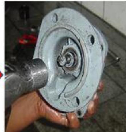
Una vez retirada la tapa se quita el seguro grande del lado del eje de mando, con pinzas para abrir seguros.
