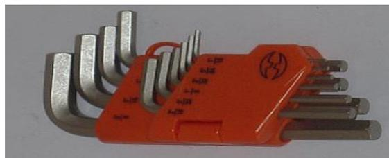
Se utilizan para sacar las tapas del amortiguador de pulsaciones, la tapa del tornillo de regulación, tapa de la bomba de engranes.
