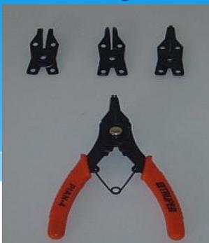
Este tipo de herramienta se la utiliza para la extracción de anillos, retenedores y seguros en la bomba. Otro uso es el de retirar el anillo de seguro del grupo de resortes normales del gobernador y también el anillo de seguro de la tapa del acelerador.
