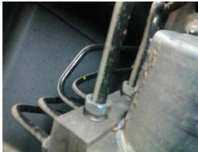
**Figura 11** Válvulas de presión de frenado
