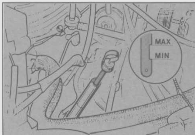
Fig. 3 - Verificación del nivel de líquido
