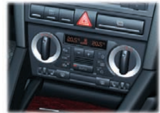
Regulación separada del aire acondicionado
