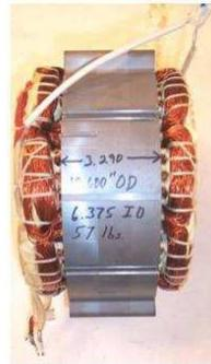
Figura 26. Estator del modelo Prius HTS2.
