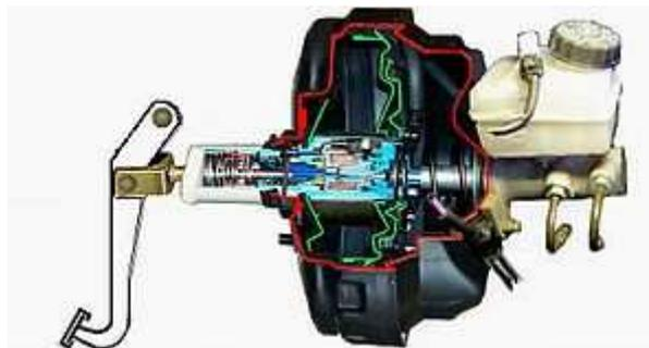
Figura 75. Sección de servofreno con el Conjunto pedal a la izquierda y la bomba a la derecha.
