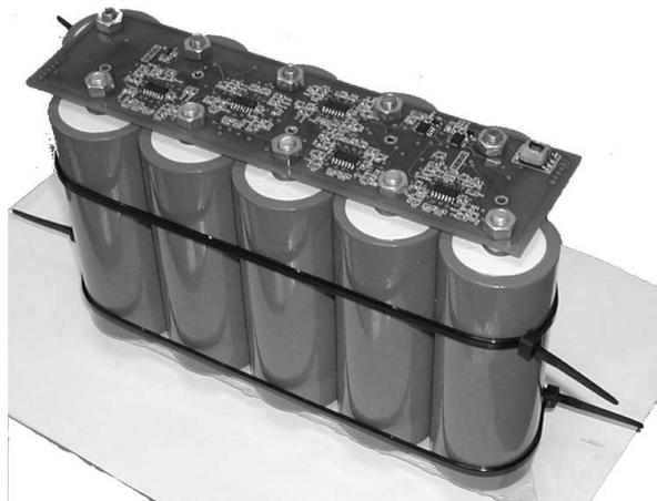
*Figura 53. Prototipo de módulo de batería de sistema de vigilancia con el estado de carga e igualar las células [12].*
