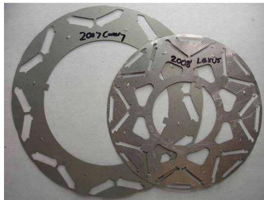
Figura 27. Comparación del rotor del Camry y del Lexus
