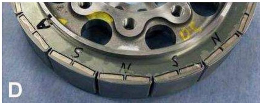
Figura 29. Rotor del Honda Accord.
