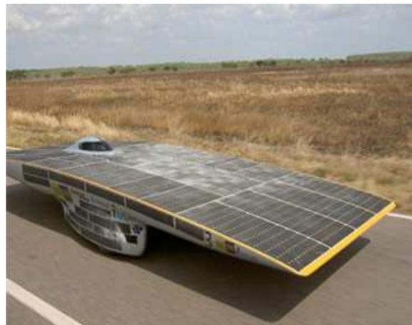
*Figura 118 Coche solar Nuna 3 participando en el World Solar Challenge (velocidad media 90 km/h, 6 m<sup>2</sup> de células solares).*
