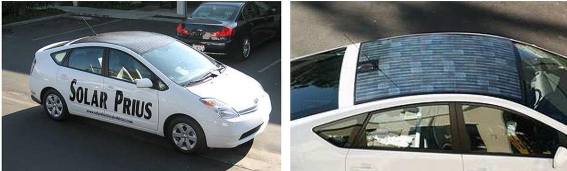
Figura 119. Toyota Prius equipado con techo solar SEV.
