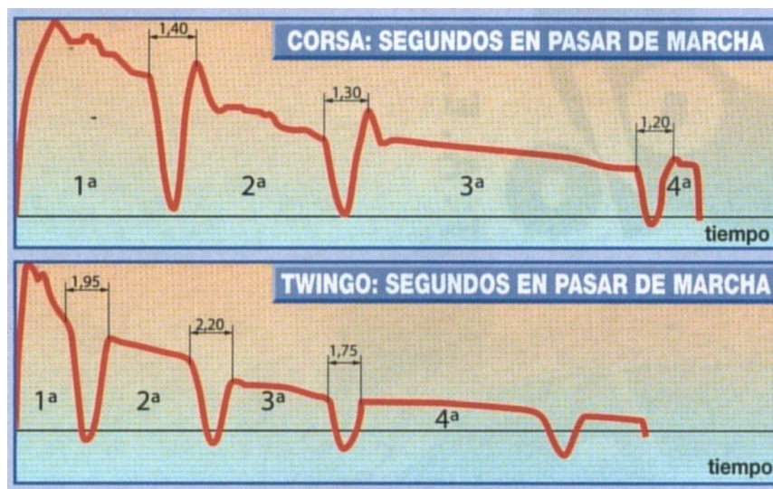
Figura 24. Comparativa entre el Easytronic (gráfica superior) y el Quickshift 5 (gráfica inferior). Aceleración a fondo en modo automático
