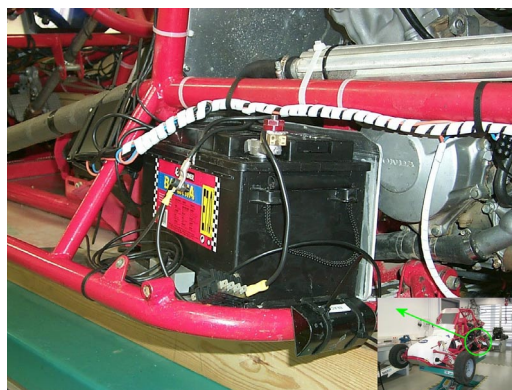
Figura 41. Ubicación de la nueva batería
