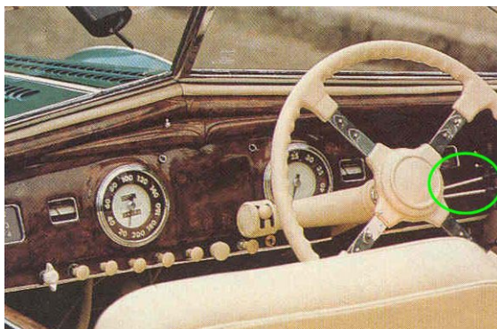
Figura 45. Cambio semiautomático Cotal con dos palancas selectoras
