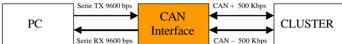
*Figura 16. Test de las funciones CAN*
