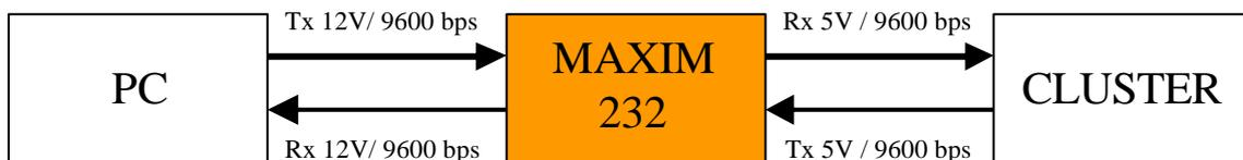
*Figura 17. Test de las funciones SERIE*
