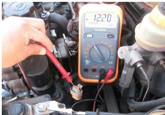
**5) Verificar las resistencias de los devanados de la bobina de encendido.**
