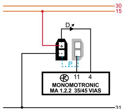
**D** Lámpara de diodo Led.
