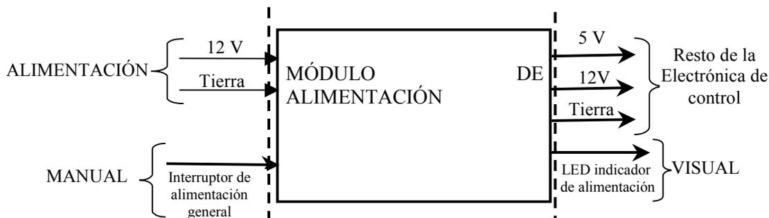
Figura 5.50: Diagrama de Entradas/Salidas del módulo de potencia
