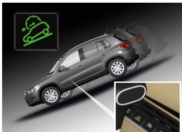
Affichage sur le combiné d'instruments et touche off-road
