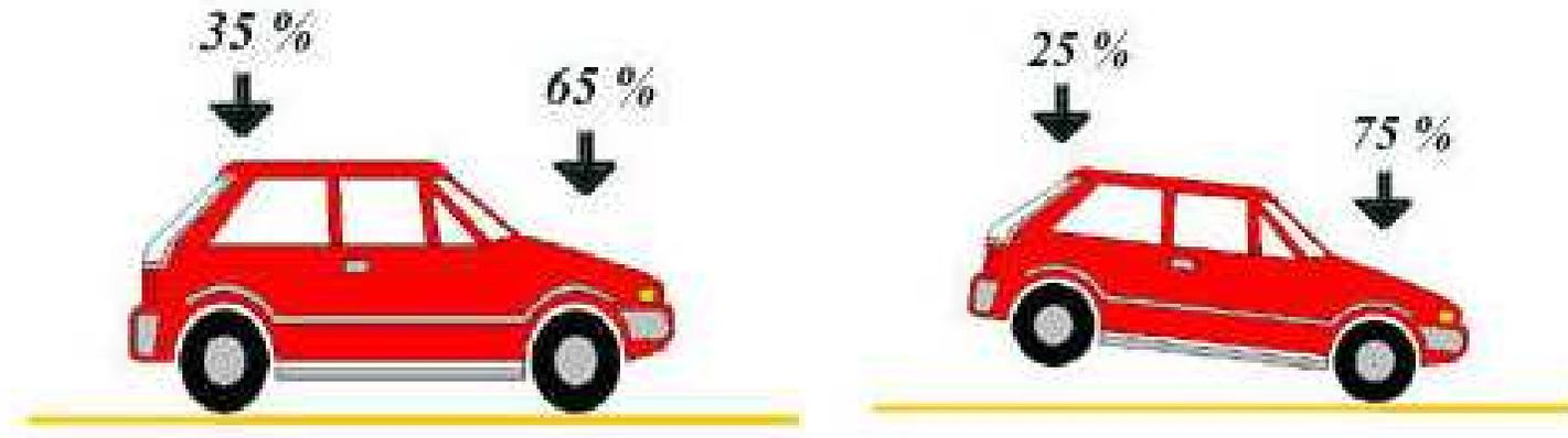
Cuando se aplican los frenos, se produce una transferencia de masa del eje posterior al delantero.
