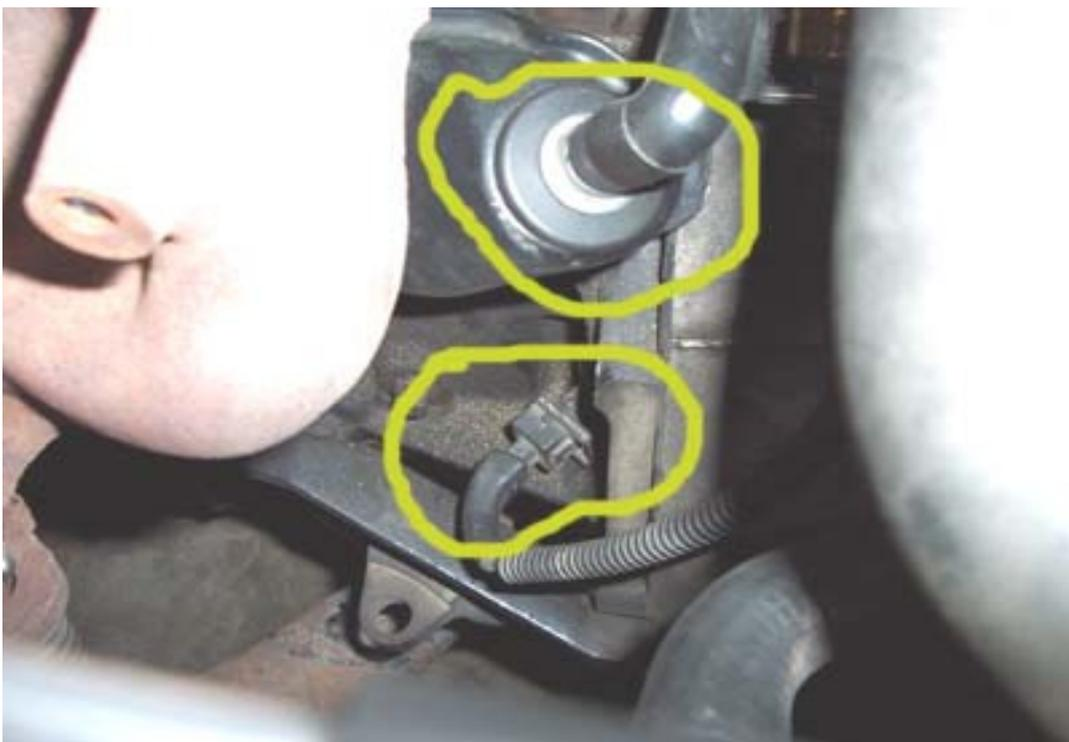
O sensor de rotação está localizado no bloco do motor direcionado para o volante. A roda fônica possui 35 dentes (36-l). A falta de um dente serve como referência para a UCE calcular o PMS dos cilindros. Através desse sensor a UCE também calcula a rotação do motor.
