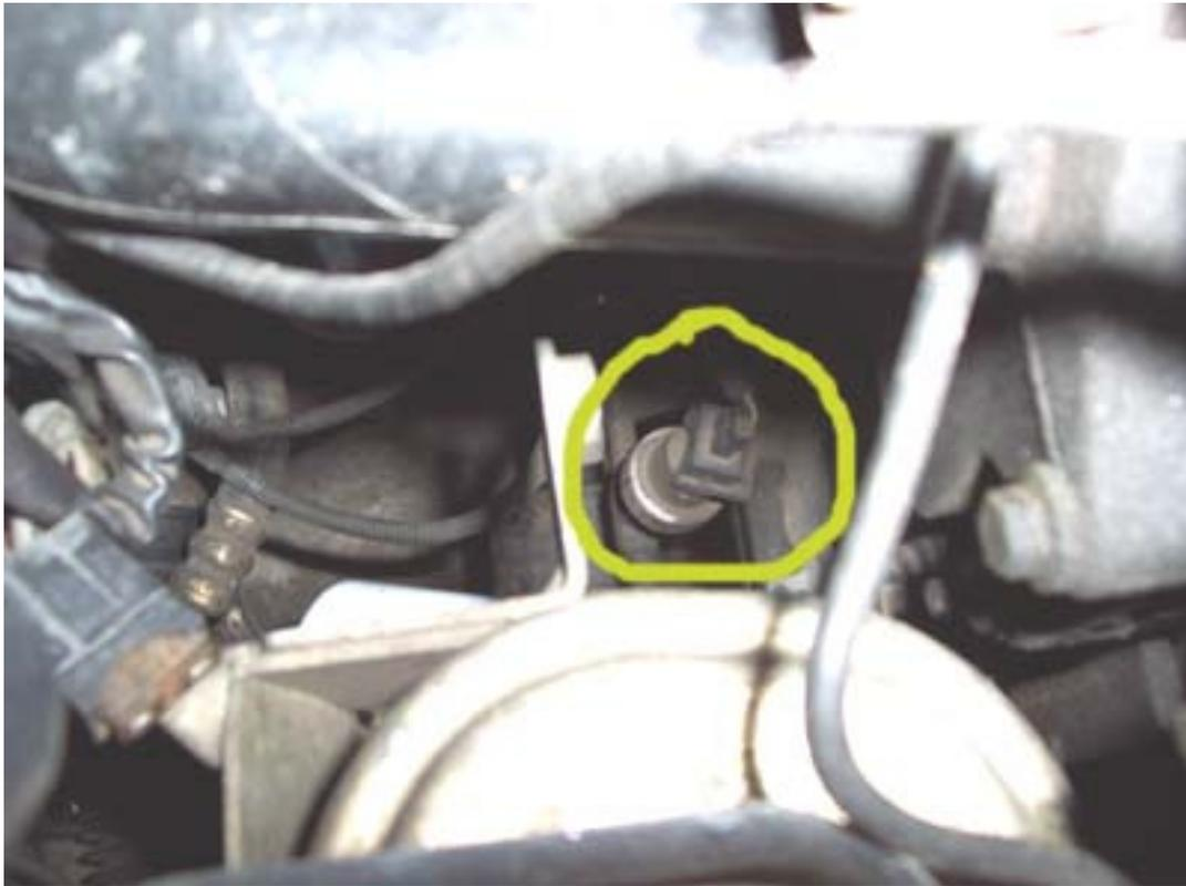
O interruptor da direção hidráulica é um interruptor normalmente fechado (NF) que informa a UCE a solicitação da direção. Com base em sua informação, a UCE efetua correções de marcha lenta. Ele se localiza entre o motor e a parede corta-chamas, ao lado esquerdo do coletor de admissão, de quem olha e frente para o carro. Fica embaixo e um pouco ao lado do coxim hidráulico do motor.
