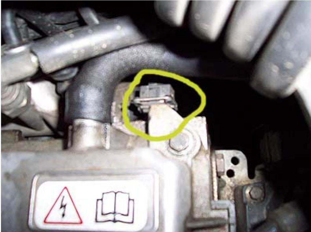
O sensor de fase está localizado na tampa de válvulas direcionado para o eixo comando de admissão. Através do sinal desse sensor, a UCE calcula o posicionamento do eixo comando de válvulas e o momento ideal de injeção de combustível. O sinal do sensor varia em função da rotação do motor e da distância do sensor e da roda fônica. Se este sensor for desconectado, o veículo funciona normalmente. A UCE passará a estimar a posição do eixo comando através do sensor de rotação.
