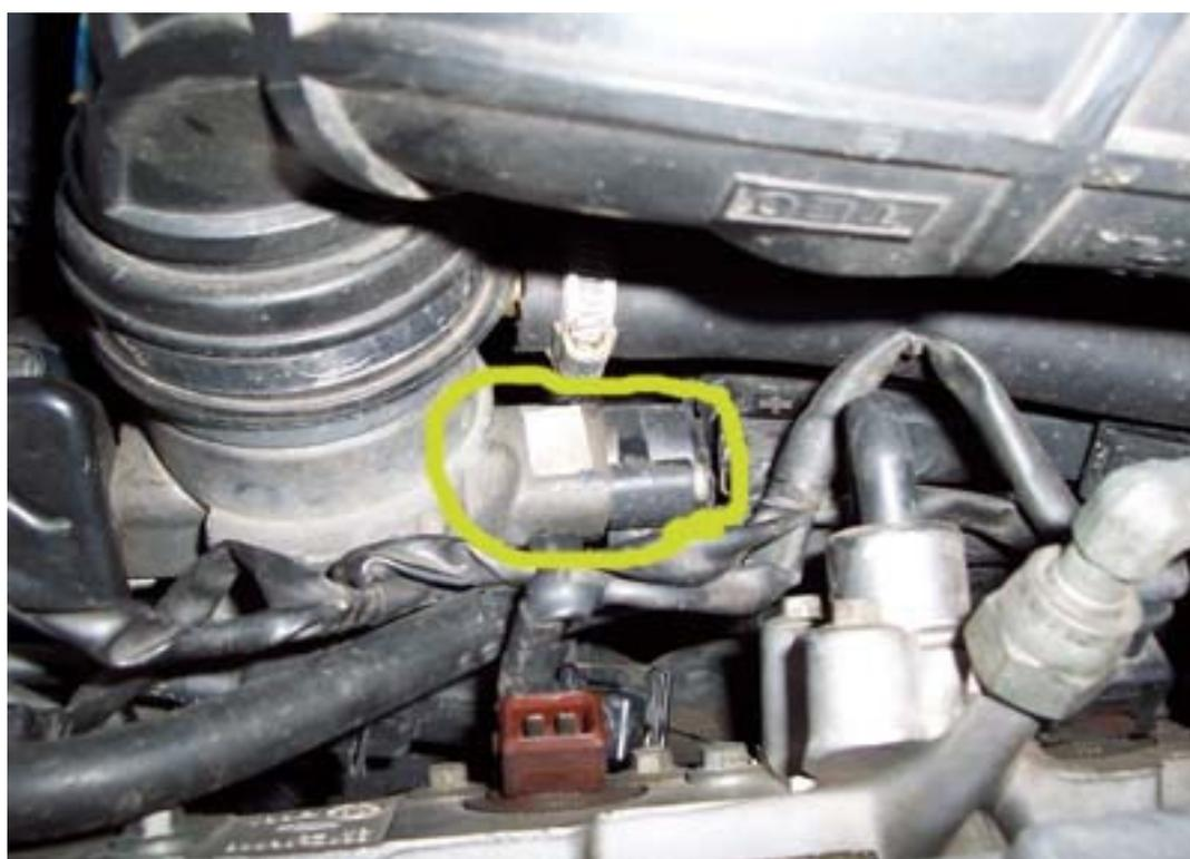
O sensor de posição da borboleta - TPS está posicionado na base do corpo de borboleta, do lado oposto ao cabo do acelerador. Informa a UCE as variações angulares da borboleta de aceleração.
