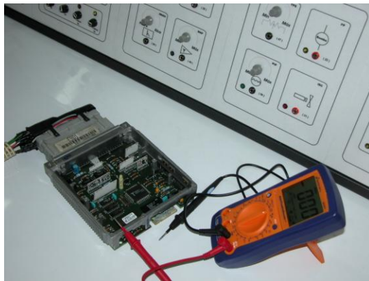
Figura 4.3 Forma de verificación interna de la UCE
