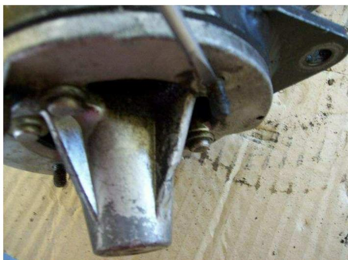
Para la colocación de las tuercas en los tornillos, colocaremos un destornillador fino en la rosca, a fin de que el tornillo al poner la tuerca no se pase hacia atrás.
