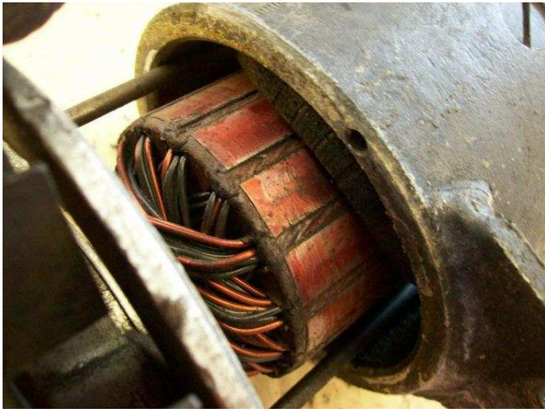
En primer lugar, vemos en el borde del cuerpo un pequeño orificio. Este se corresponde con un tetón de guía que posee la tapa y que habrán de coincidir. Esto es para que ambas tapas únicamente se puedan montar en una posición y que así coincidan los tornillos de fijación que van de la tapa anterior a la posterior.
