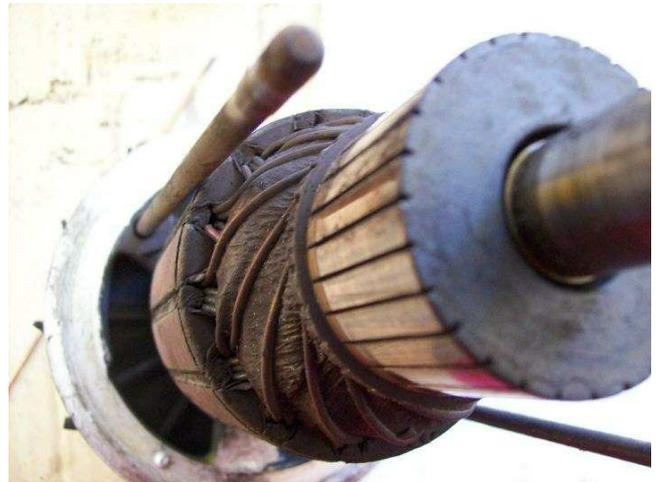
Procederemos ahora con el desmontaje de la parte anterior del inducido, que contiene la polea, aspas de ventilación y el rodamiento del eje. Para ello
