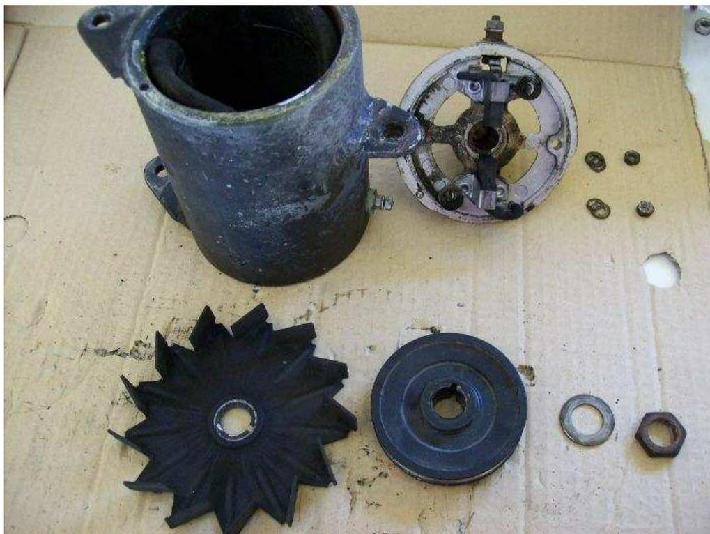
Y aquí, el interior de la carcasa de la dinamo, donde están alojadas las bobinas inductoras. Estas bobinas
