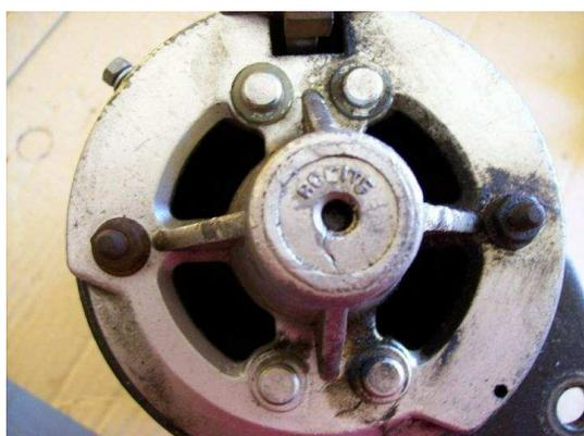
En una vista posterior de la dinamo vemos un pequeño orificio donde está la leyenda “ACEITE”. Ese orificio sirve para la lubricación del eje en su parte posterior, por donde con la frecuencia que indique el fabricante (personalmente opino que cada 1500 kms es más que suficiente), introduciremos una cierta cantidad de **aceite de motor**. No es conveniente que el aceite sea muy fluido ni en spray, ya que la elevada temperatura que toma la zona por la proximidad al escape hace
