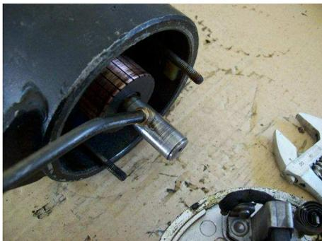
Ahora encajaremos la tapa trasera. para ello deberemos levantar las escobillas que nos toparán en colector. Para ello ladearamos ligeramente la tapa y levantando la escobilla más próxima al colector con un destornillador fino, empujaremos la tapa hasta que la escobilla monte en las delgas.
