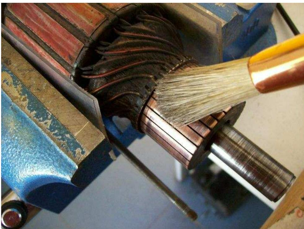
Para la limpieza del colector, bajo ningún concepto se utilizarán productos químicos, y menos tricloretoano o similares, ya que pueden deteriorar el aislante de baquelita de soporte de las delgas. Con este, ya tenemos casi el mantenimiento de la dinamo.
