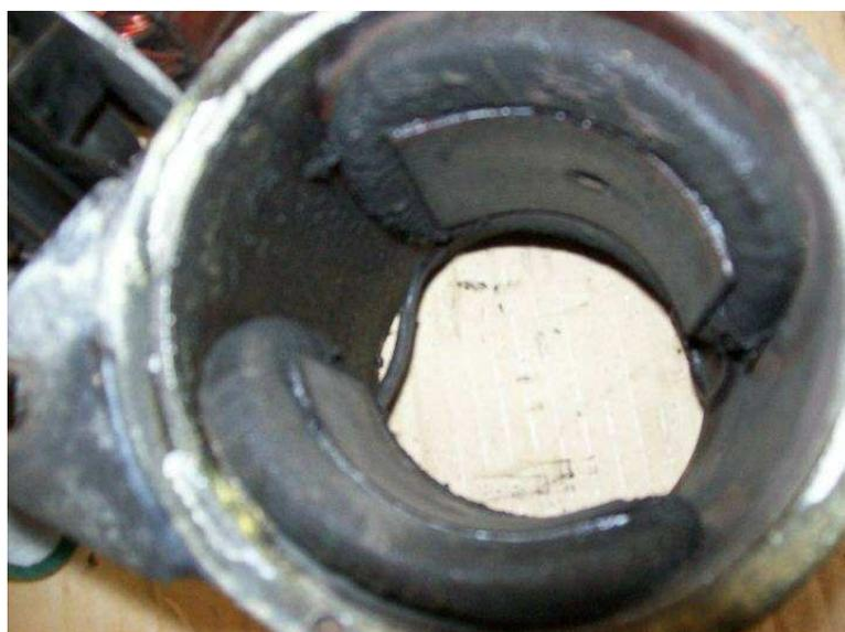
(o piezas polares) van fuertemente sujetas por los núcleos mediante unos tornillos que los sujetan a la carcasa. Para el desmontaje en caso de reparación se necesitará de un destornillador de impacto, ya que es necesario que queden fijadas con la máxima solidez posible.
