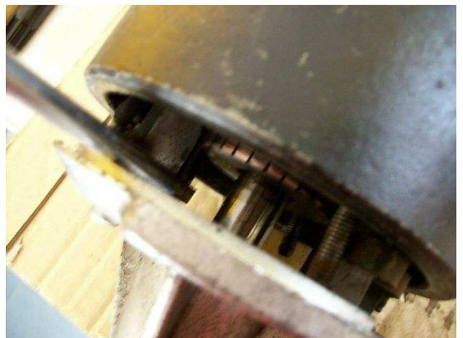
El penúltimo paso para el montaje es la colocación de los tornillos, que habremos de sujetar con un alicate de puntas para poder introducirlos en los orificios de la tapa.
