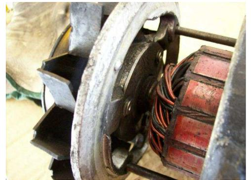
Una vez tenemos colocada y posicionada la tapa anterior, previo al montaje de la tapa posterior, procederemos a una ligera lubricación del eje con aceite de motor.
