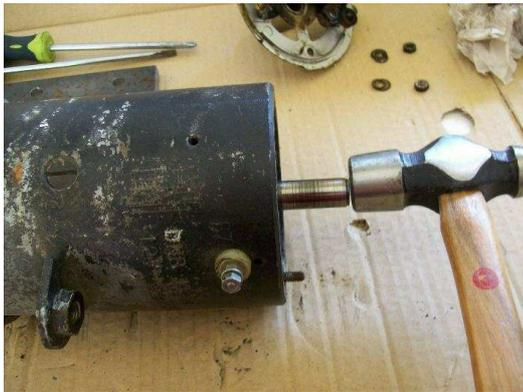
Sujetando fuertemente la carcasa, con un martillo (preferentemente de fibra) daremos un golpe seco en el extremo del eje, y con ello conseguiremos que ceda la tapa anterior y se desenganche del cuerpo.
