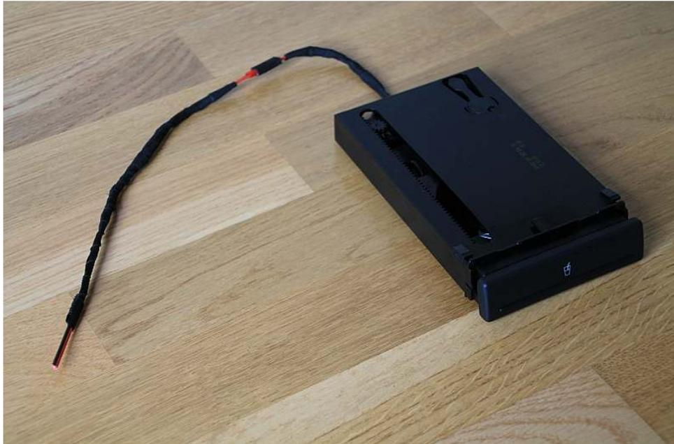
Para terminar con el brico nos quedaría conectar los cables a cualquiera de los botones (ESP por ejemplo). Podemos seguir el siguiente esquema siendo los pines 1-positivo, 3-negativo.
