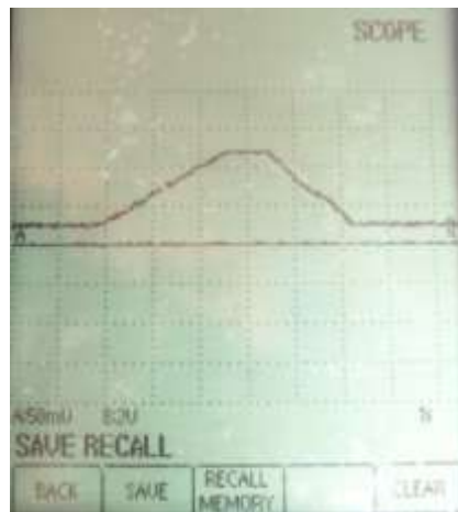
Gráfica característica del Sensor de Posición de la Mariposa (TPS) obtenidas en el osciloscopio. (Fuente: Los Autores.)
