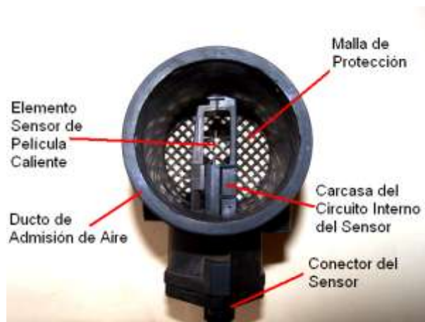
Composición interna del Sensor de Flujo de Masa de Aire (MAF). (Fuente: Los Autores.)
