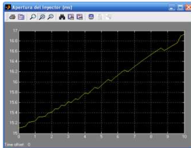
Gráficas del Tiempo de Apertura del Inyector en Modo Aceleración. (Fuente: Los Autores.)
