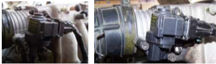
Ubicación del Motor de Control de velocidad de Ralentí (IAC). (Fuente: Los Autores.)
