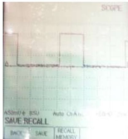
Onda característica de la Válvula de Control de Aire de Ralentí IACV obtenida en el osciloscopio (Bobina de Apertura) (Fuente: Los Autores.).
