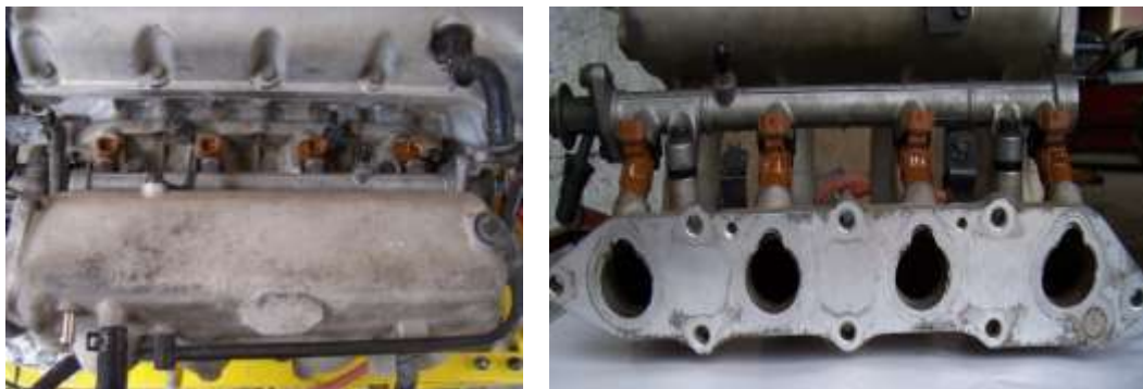
Ubicación de los Inyectores. (Fuente: Los Autores)
