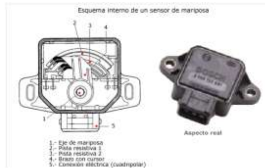
Sensor de posición de la válvula de aceleración. (Fuente: “SENSORES DEL AUTOMÓVIL” www.mecanicavirtual.iespana.es )
