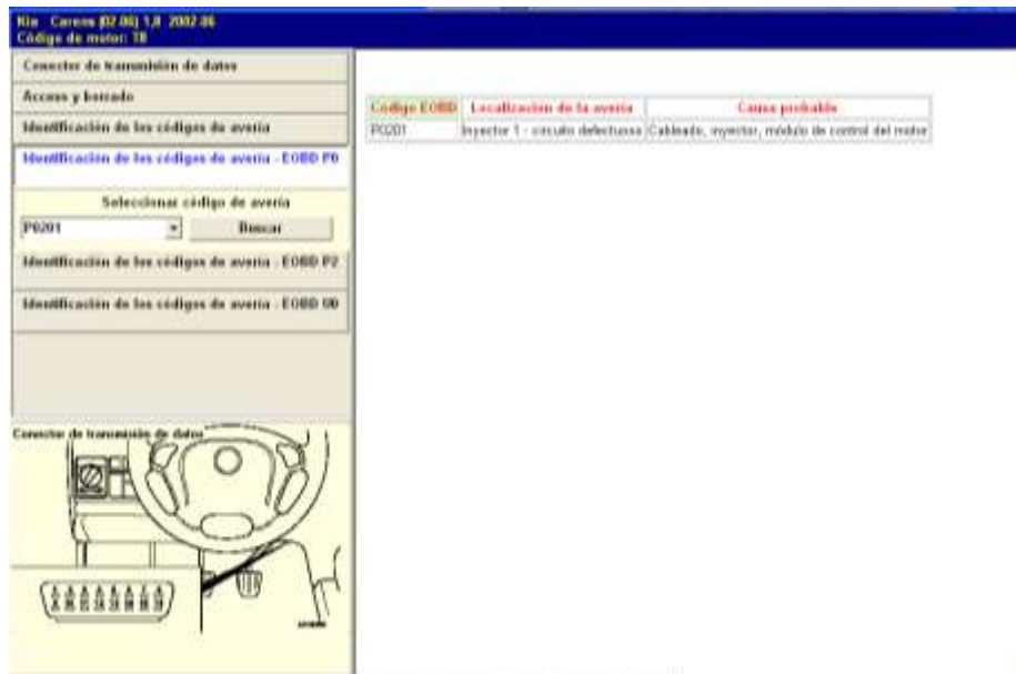
Descripción específica del código de fallo del Inyector. (Fuente: Los Autores)
