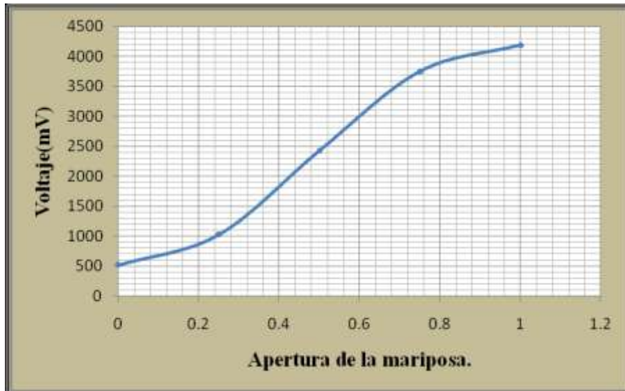
Curva real apertura-- voltaje del Sensor de Posición de la Mariposa (TPS). (Fuente: Los Autores.) Fig. 2.54.
