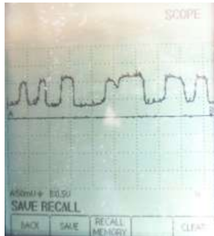
Gráfica característica del Sensor de Oxígeno obtenidas en el osciloscopio. (Fuente: Los Autores.)
