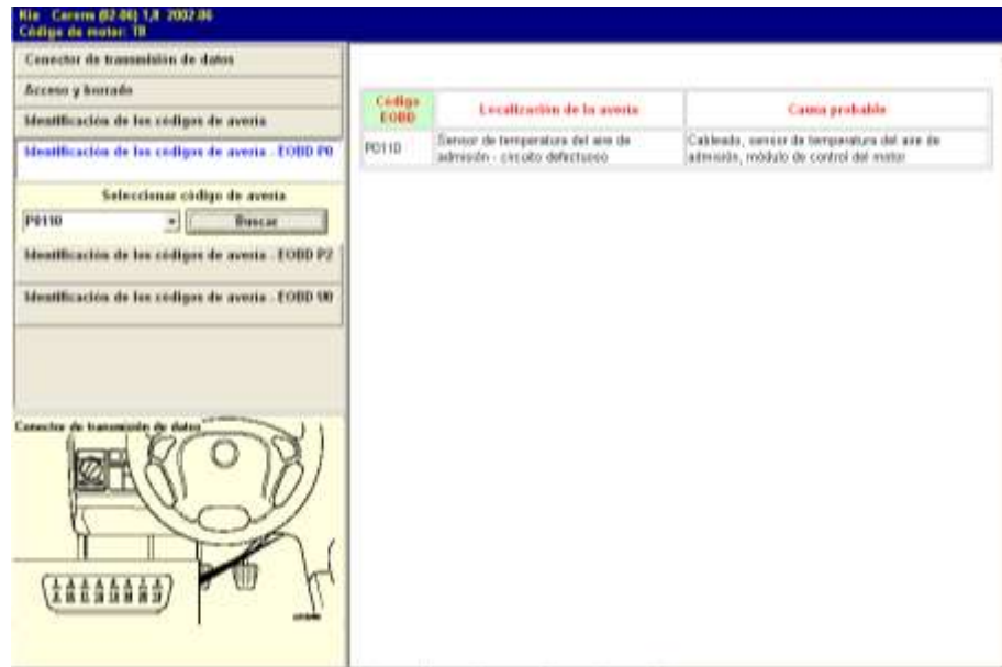
Descripción específica del código de fallo de la IAT. (Fuente: Los Autores)
