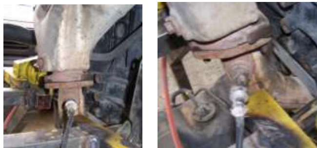
Ubicación del Sensor de Oxígeno Calentado (O2). (Fuente: Los Autores.)
