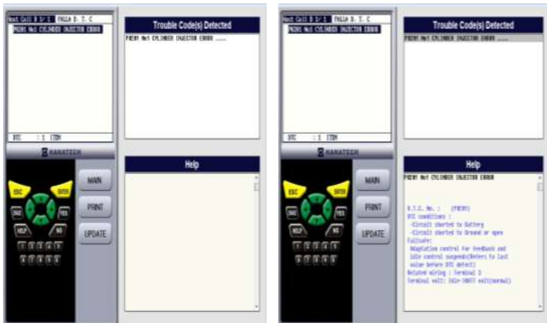
Lectura del fallo del inyector. (Fuente: Los Autores)
