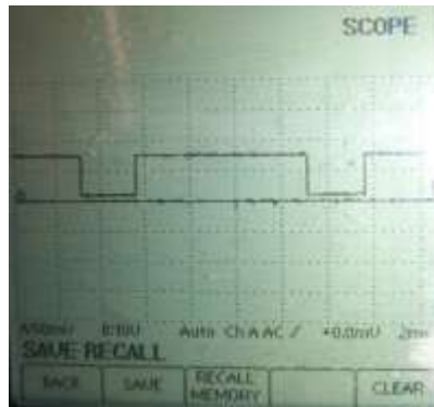
Onda característica de la Válvula de Control de Aire de Ralentí IACV obtenida en el osciloscopio (Bobina de Cierre) (Fuente: Los Autores.).
