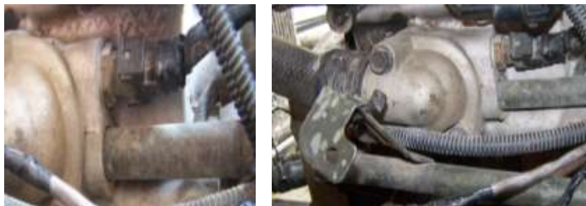
Ubicación del Sensor de Temperatura del Refrigerante del Motor (ECT). (Fuente: Los Autores.)
