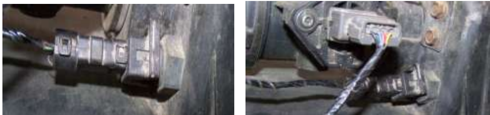
Ubicación del Sensor de Temperatura del Aire (IAT). (Fuente: Los Autores.)
