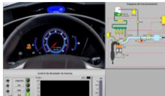
Indicador de avería TPS. (Fuente: Los Autores)
