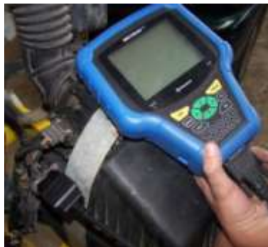
Conexión del Escáner. (Fuente: Los Autores)
