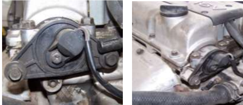
Ubicación del Sensor de Posición del Árbol de Levas (CMP). (Fuente: Los Autores.)
