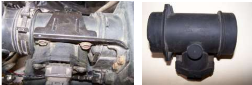
Ubicación del Sensor de Flujo de Masa de Aire (MAF). (Fuente: Los Autores.)
