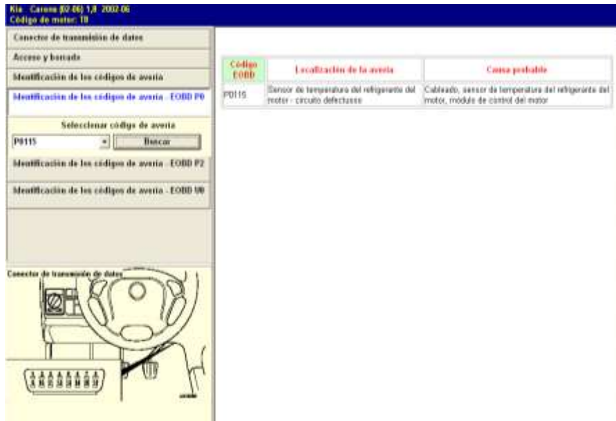
Descripción específica del código de fallo de la ECT. (Fuente: Los Autores)
