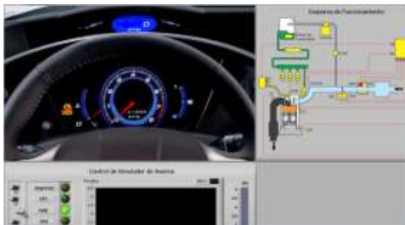
Indicador de avería MAF. (Fuente: Los Autores)
