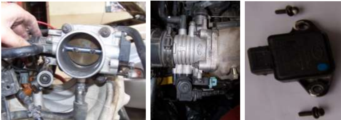
Ubicación del Sensor de Posición de la Mariposa (TPS). (Fuente: Los Autores.)
