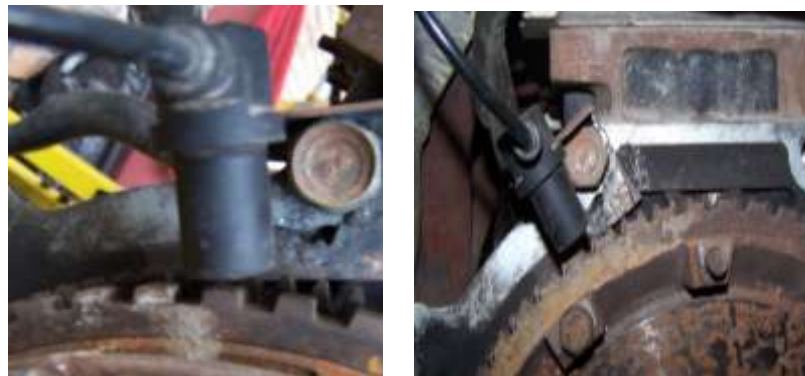
Ubicación del Sensor de Posición del Cigüeñal (CKP). (Fuente: Los Autores.)
