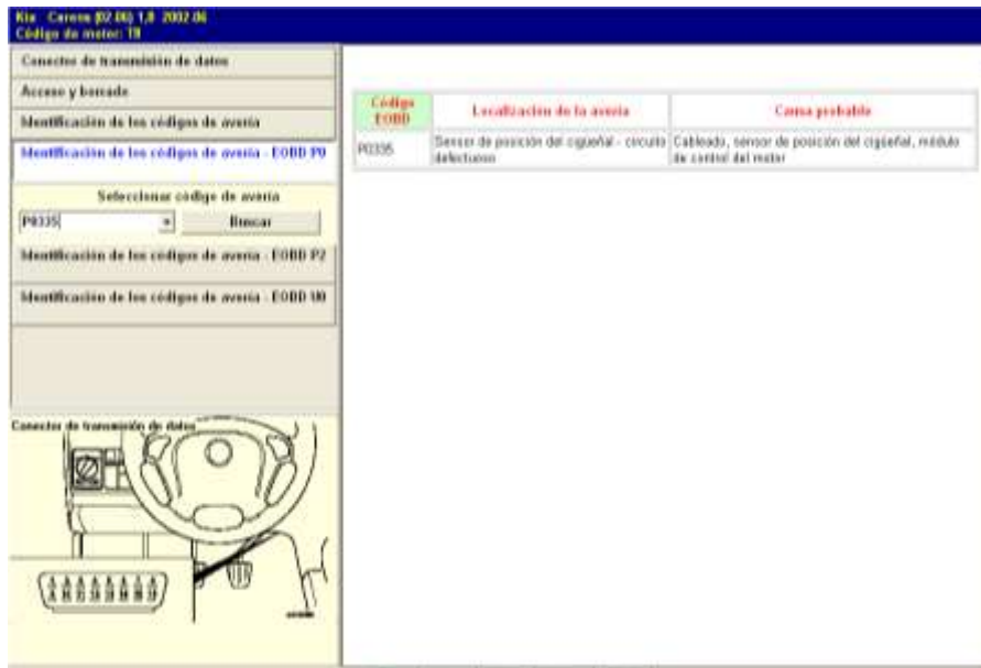
Descripción específica del código de fallo de la CKP. (Fuente: Los Autores)
