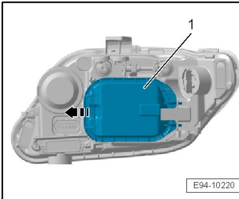
Desenclavar el resorte de sujeción - flecha- y retirar la -tapa de la carcasa -1- para luz de posición, separándola de la carcasa del faro.
