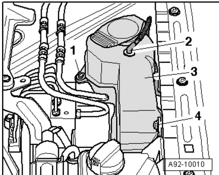
Desmontar el elemento inferior del depósito
