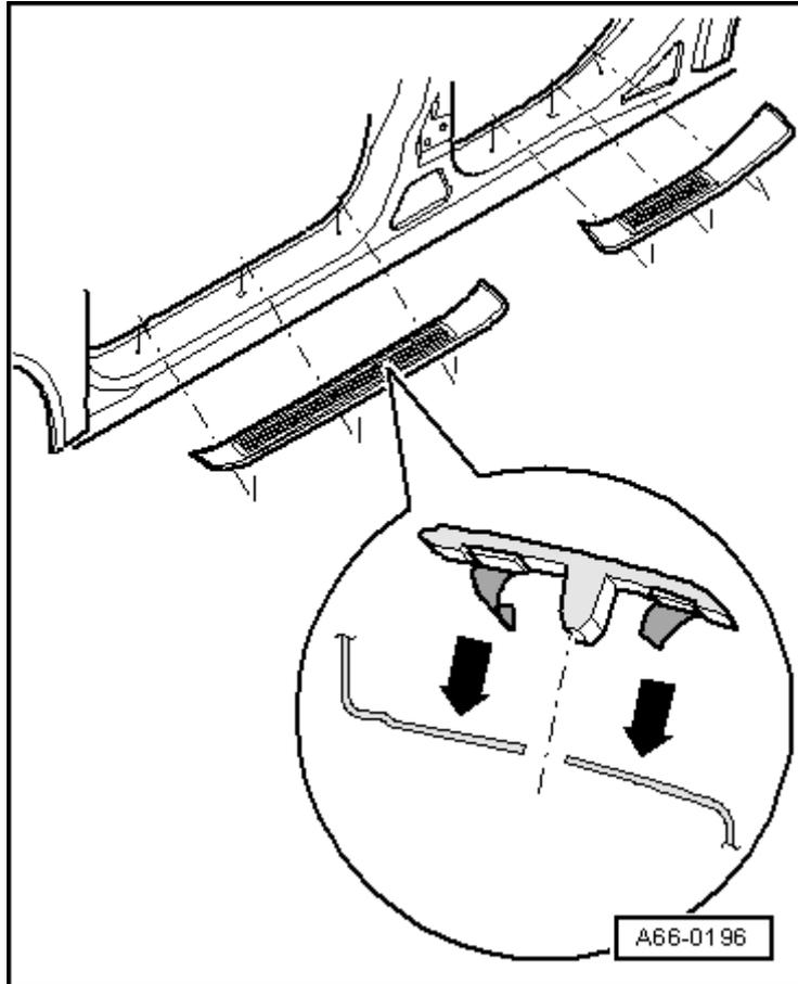
Retirar la lámina protectora de la cinta de dos caras adhesivas poco antes de proceder al montaje.
