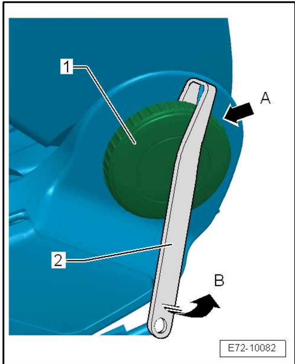
**Asidero para reglaje de la altura del asiento: desmontar**
