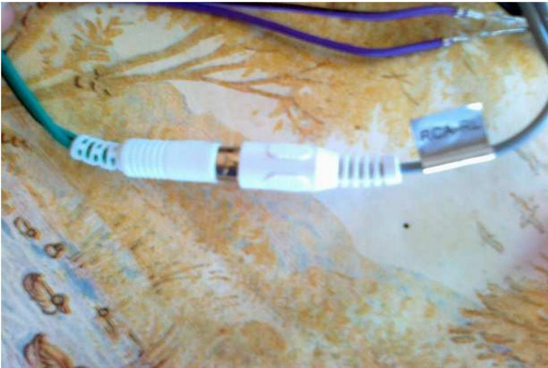
Fijaros que el verde es para el conector etiquetado como RCA-RL (el trasero izquierdo) y el morado para el RCA-RR (trasero derecho)
