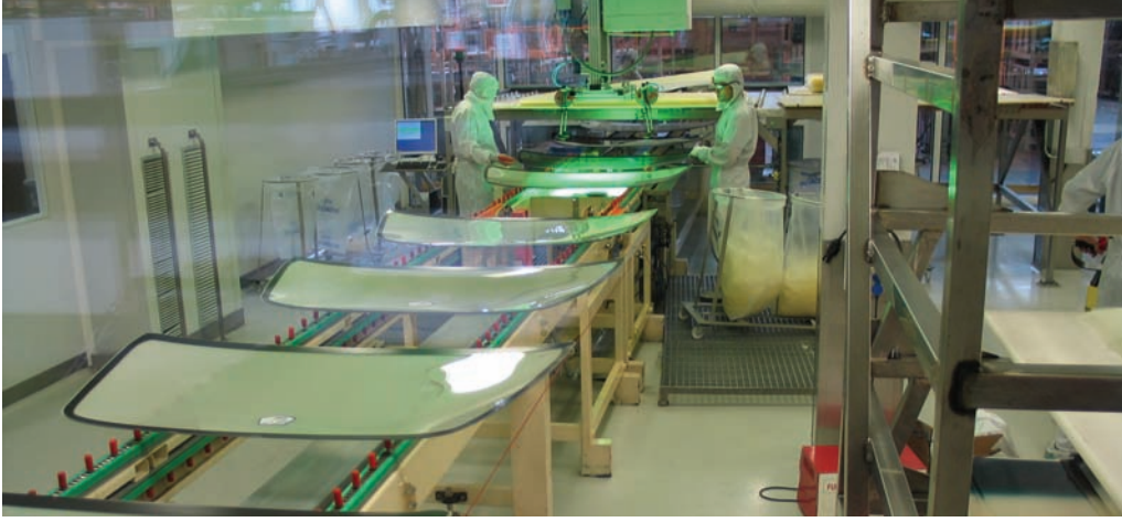
Colocación de la lámina de PVB en la fábrica de Guardian Glass
