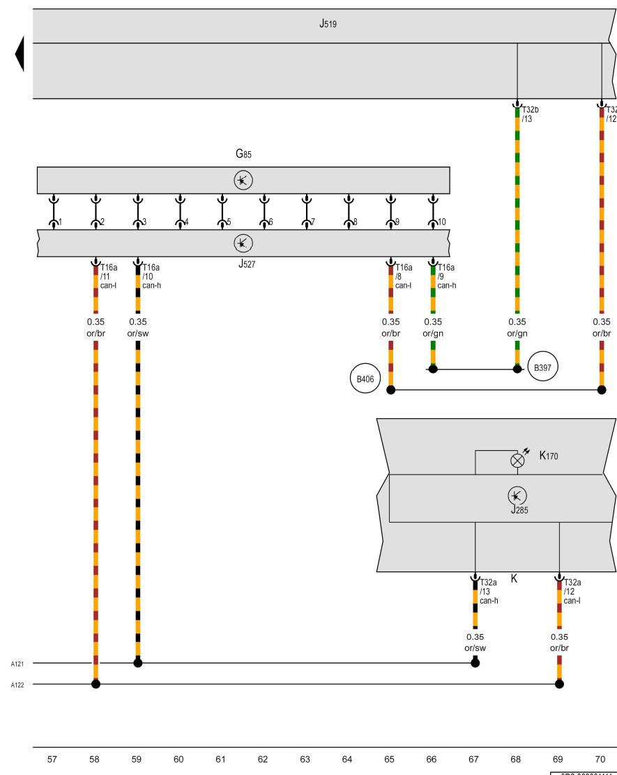
**Sensor del ángulo de giro del volante, Unidad de control de la red de a bordo, Unidad de control de la electrónica de la columna de la dirección, Cuadro de instrumentos, Testigo de avería de lámpara**
